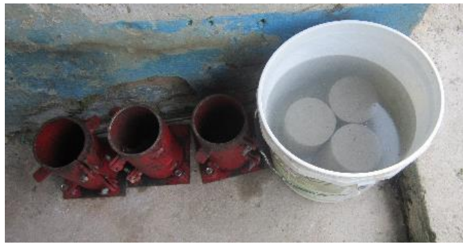
Figura 73. Curado de probetas de concreto
