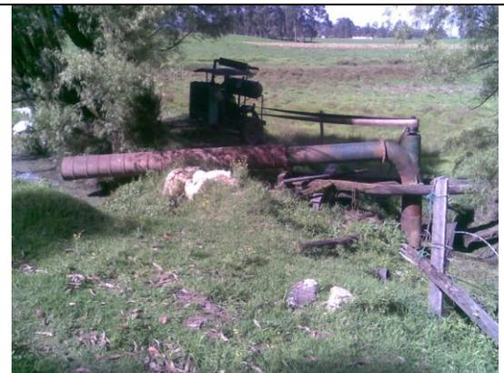
FOTO 174. Bomba que pasa las aguas residuales de las fincas al canal que llega al Río Bogotá - Zipaquirá
