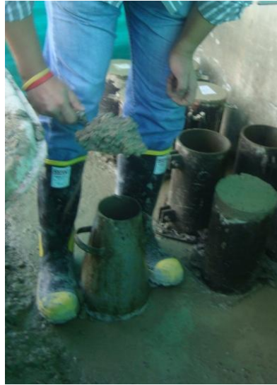
Figura 3 Asentamiento mediante el cono de Abrams.
