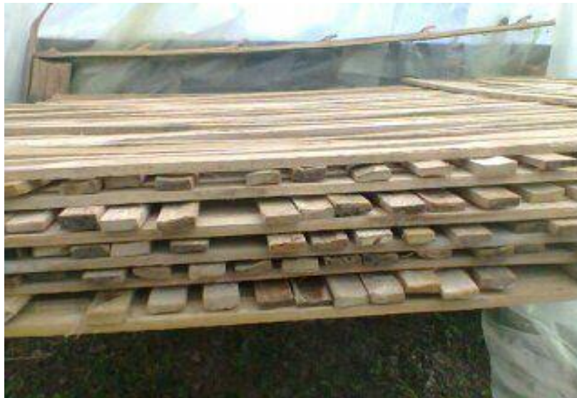
Figura 8. Almacenamiento de tablillas sin nudos 13
