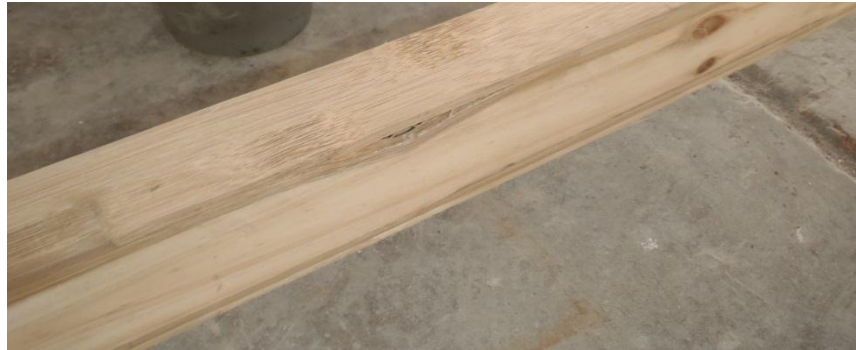
Figura 27. Aplastamiento en el punto de aplicación de la carga
