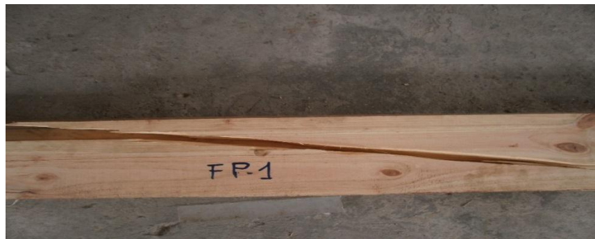
Figura 28. Probeta en pino fallada por cortante
