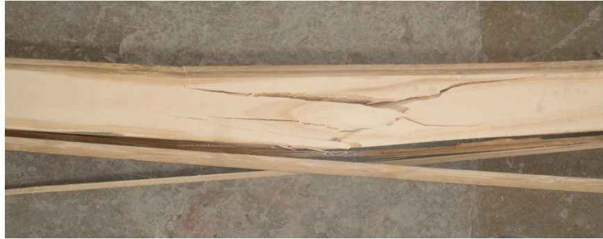
Figura 29. Probeta laminada fallada por tracción
