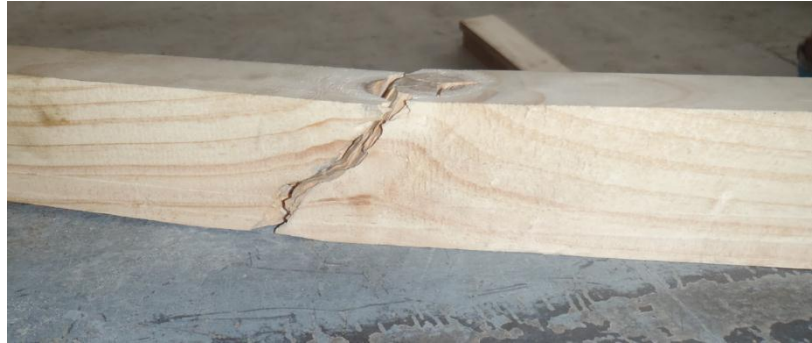
Figura 25. Nudo que ocasiona la falla del elemento
