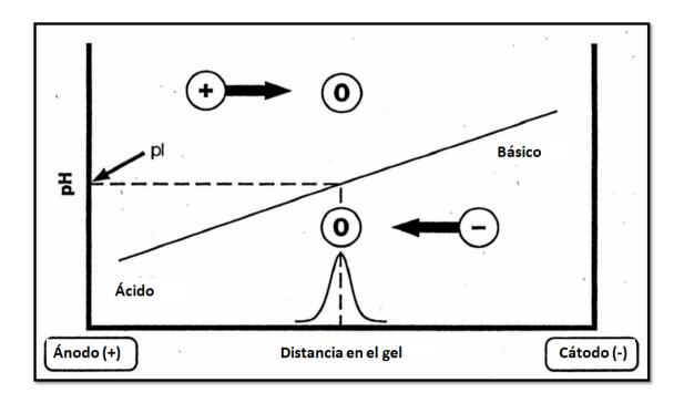
Las proteínas se aproximan a su punto isoeléctrico a velocidades variables, pero permanecen ubicados en este por tiempos prolongados, en contraste con la electroforesis convencional en la cual las proteínas se continúan moviendo por el medio hasta que el campo eléctrico es removido <sup>22</sup>.
