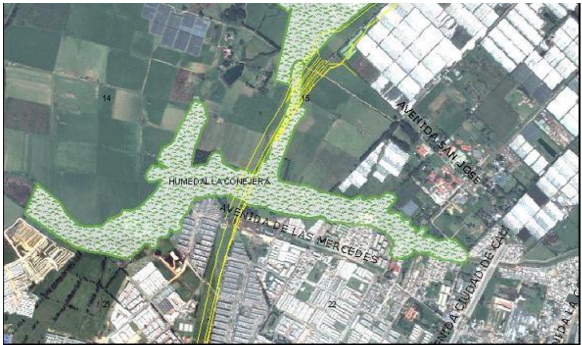
Figura 4. Trazado sobre fotografía aérea. En el tercer tramo, la ALO cruzará el Humedal La Conejera a través de un puente vehicular [28]
