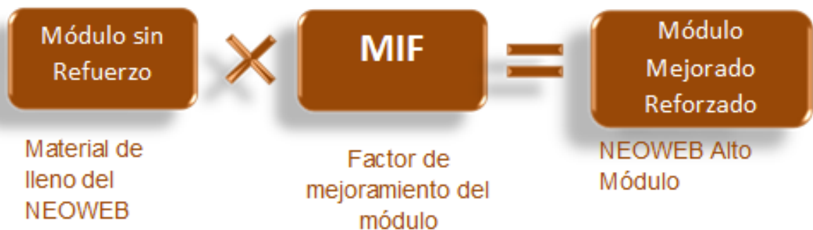
Figura 3. Fórmula del cálculo del módulo mejorado reforzado Fuente. Manual de Diseño con Geosintéticos, 9 ed. Geosistemas Pavco. 2012
