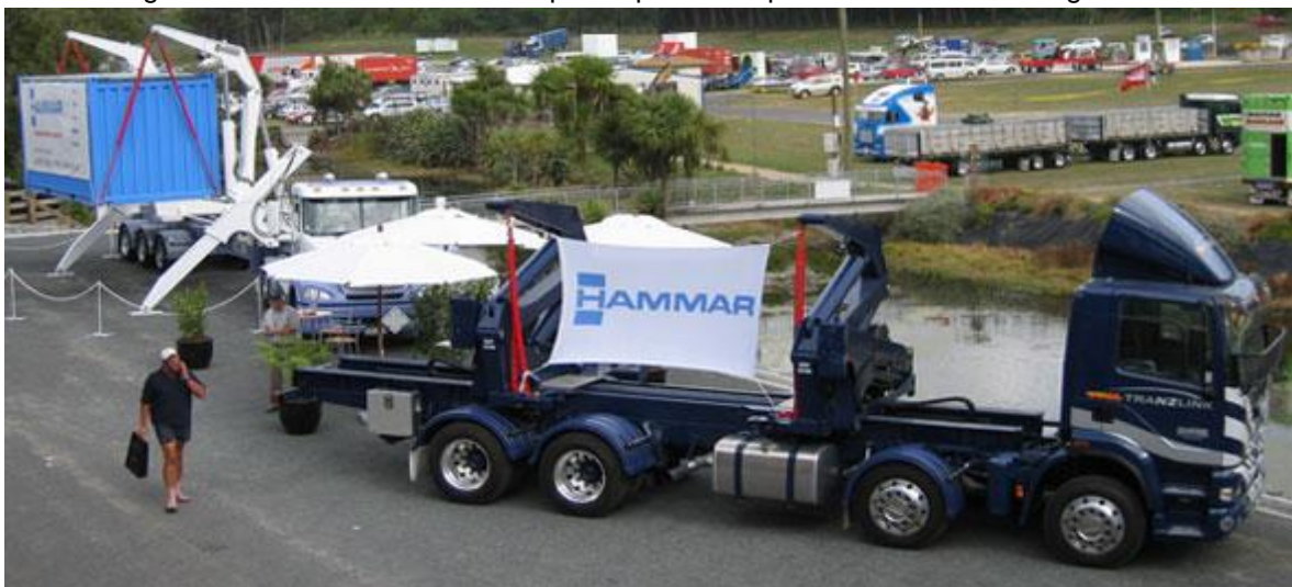
Figura No. 1 Modelo de camión tipo C4 para transportar contenedores High Cube
