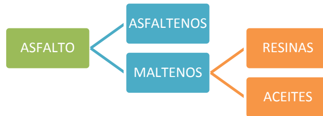
Figura 2. Composición del asfalto
