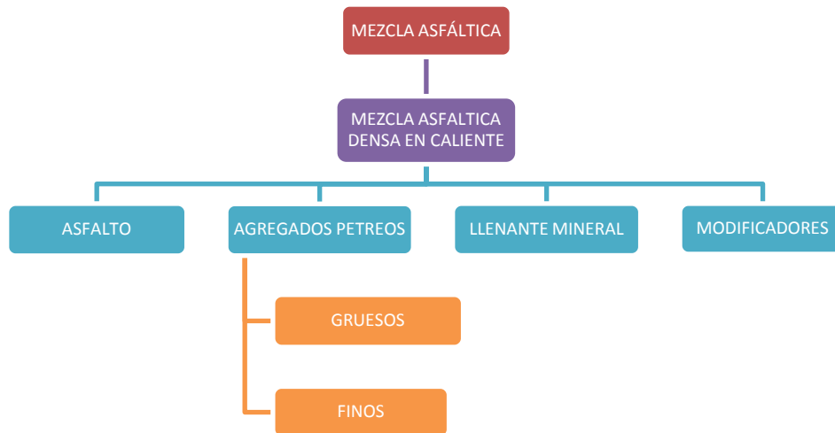
Figura 1. Componentes de una mezcla asfáltica
