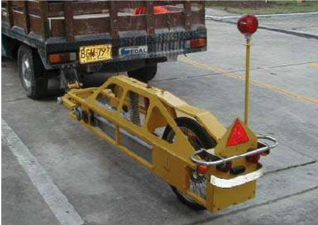
Figura 40. Vehículo haciendo medidas del IRI en una carretera. (Fuente archivo personal de los autores).
