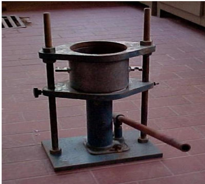
Fotografía 6. El extractor de la muestra de los moldes. La palanca del gato y el marco del equipo.
