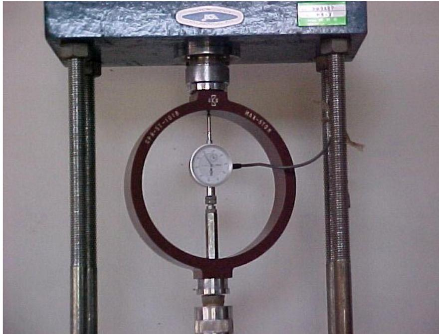
Fotografía 3. El marco de carga, el anillo y el dial de deformaciones.
