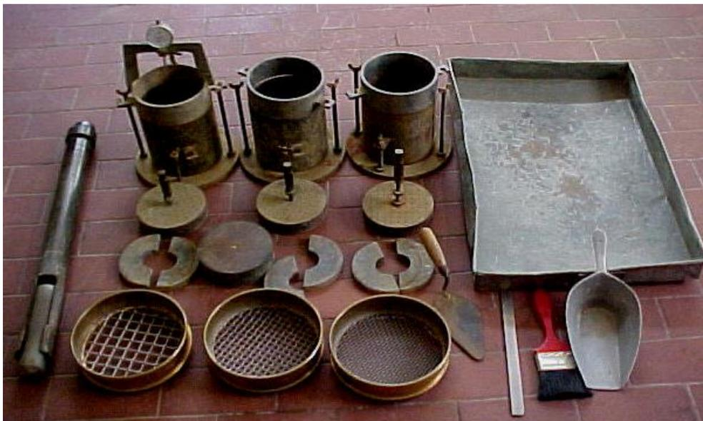
Fotografía 1. El equipo C.B.R. para realizar, el tamizado, humedecimiento, la mezcla de suelo y la compactación.
