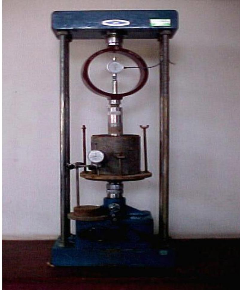
Fotografía 2. El equipo manual de C.B.R. La muestra está instalada, el anillo y su dial de deformaciones, el dial para medir las deformaciones y el pistón de 19.4 cm<sup>2</sup> de área transversal.
