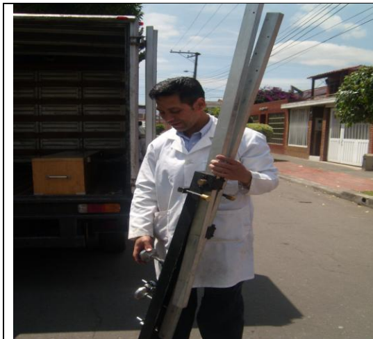
Fotografía 6. Parte fija de la Viga Benkelman.
