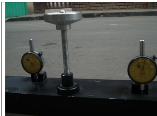
Fotografía 15. Deformímetros en cero.
