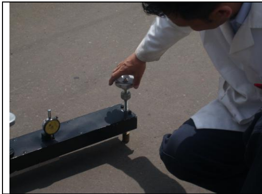
Fotografía 13. Nivelación de la viga.
