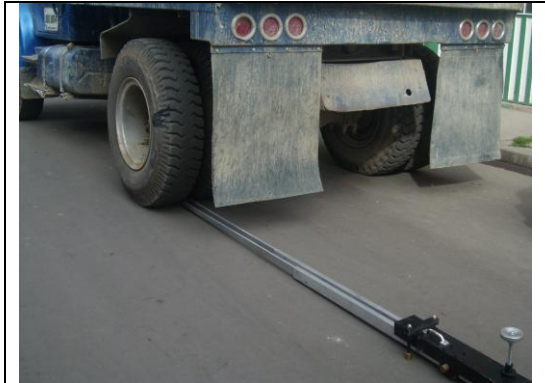
Fotografía 11. Verificación de posición de la Viga Benkelman.
