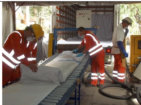
Fotografía 38. Colocación del polímero en la manga
