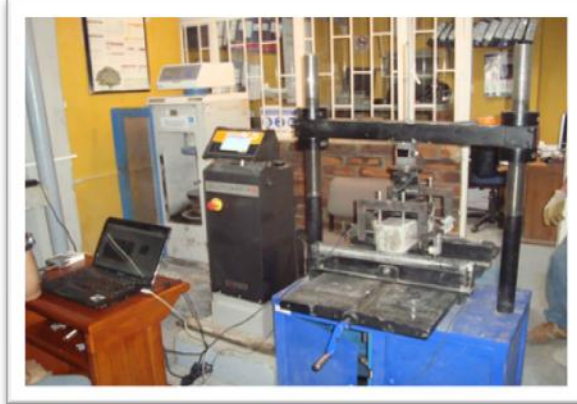
Figura 6. Equipo necesario para realizar la prueba ASTM C 1399
