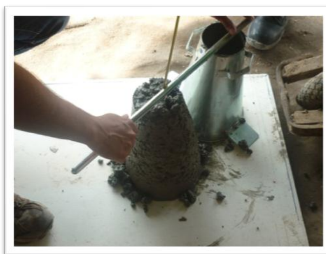
Figura 4. Prueba de asentamiento (slump)
