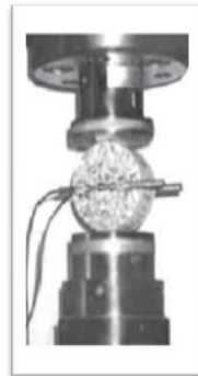
Figura 9. Instrumentación del ensayo a tracción indirecta
