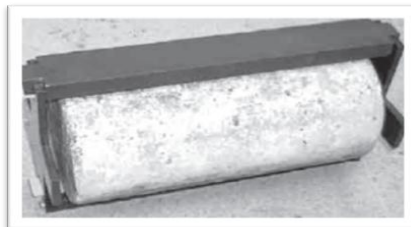
Figura 10. Ejemplo físico de probeta configurada para ensayo a tracción indirecta, método brasileño
