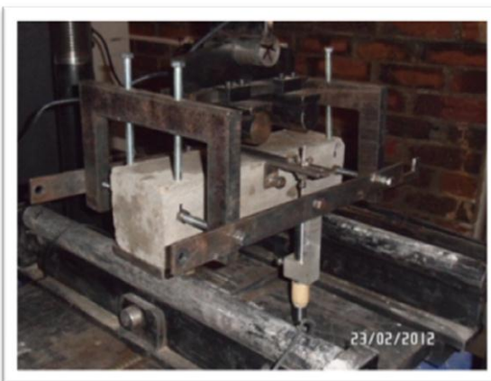
Figura 5. Montaje del ensayo ASTM C 1399
