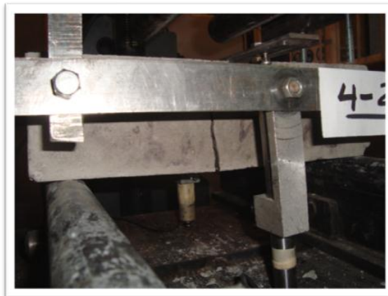
Figura 8. Viguetas en el punto de fractura
