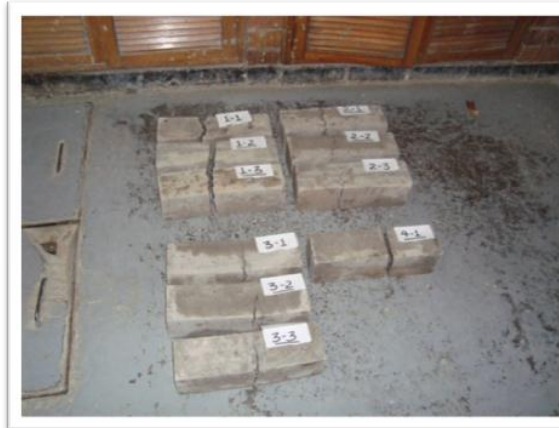
Figura 7. Viguetas falladas con las diferentes mezclas reforzadas con fibras sintéticas y reforzadas con fibras metálicas) (simples,
