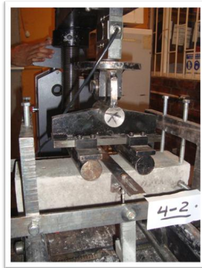
Figura 9. Distribución uniforme de las cargas según la prueba según ASTM C 1399
