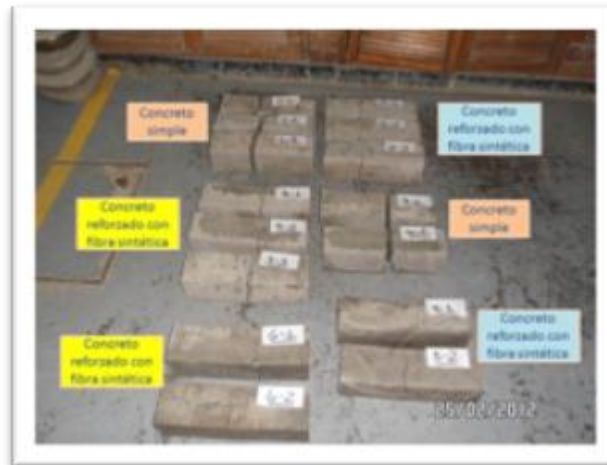
Figura 10. Viguetas falladas después del ensayo ASTM C 1399
