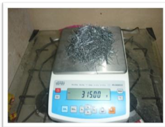
Figura 2. Pesaje de las fibras metálicas
