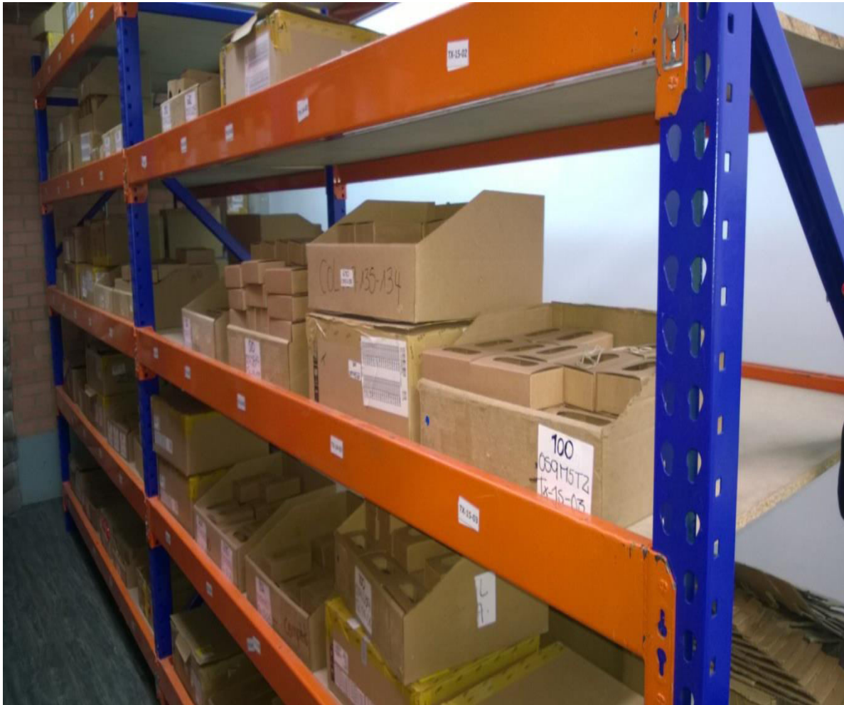
Figura 1. Almacenamiento recomendado (Racks con pintura electro estatica)
