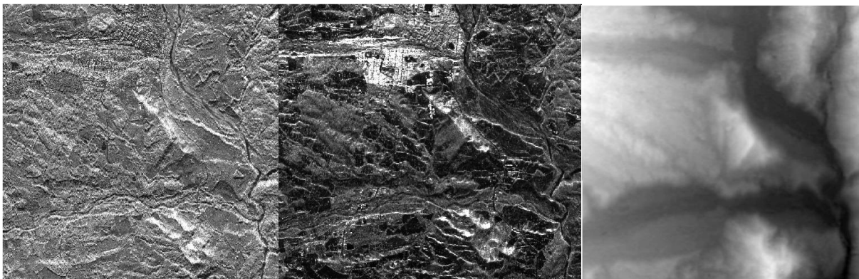
Figura 5. Productos GeoSAR, Banda X, Banda P y DEM de Banda P. Fuente: Autor.
