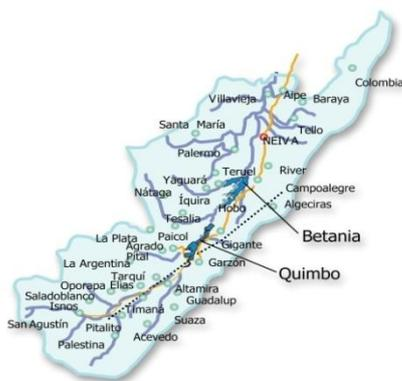
El Proyecto contempla la formación de un embalse sobre el río Magdalena mediante una presa en el sector encañonado denominado El Quimbo, localizado unos 1300 m aguas arriba de la confluencia del río Páez con el río Magdalena, el cual permitirá la generación de energía en una central hidroeléctrica de 400 MW de potencia.
