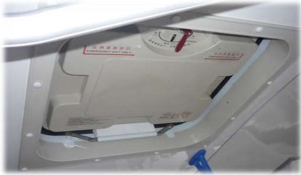
Figura 9. Claraboya en estructura de techo – unidad de transporte
