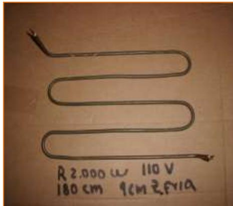
En alambres o varillas gruesos esta disposición es muy conveniente para conseguir una elevada potencia específica en kW. Se emplean varillas de 5 a 8 mm de diámetro, soportadas por ganchos metálicos de acero refractario o cerámico de silimanita
