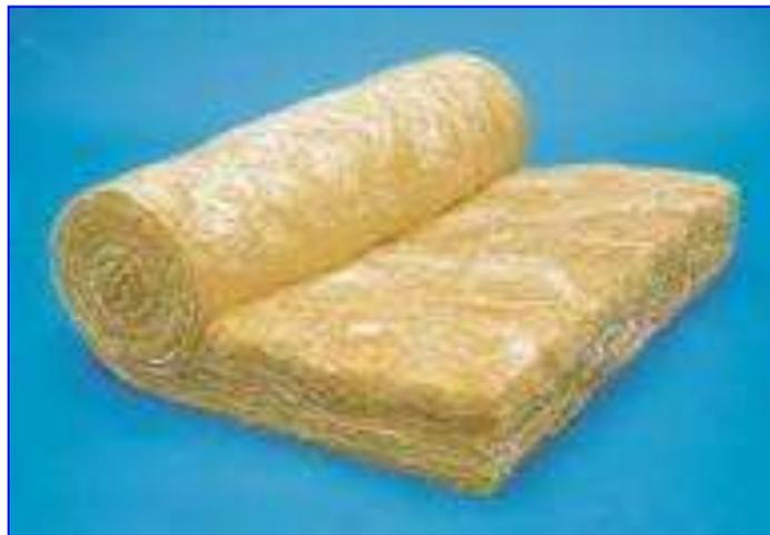
**La fibra de vidrio** (del inglés fiberglass) es un [material](#) fibroso obtenido al hacer fluir [vidrio](#) fundido a través de una pieza de agujeros muy finos ([espinerette](#)) y al solidificarse tiene suficiente flexibilidad para ser usado como fibra. Sus principales propiedades son: buen aislamiento térmico, inerte ante ácidos, soporta altas temperaturas. Existen varios tipos de fibra. Se clasifican, según el tipo de vidrio y según la disposición espacial. Dentro de los tipos de
