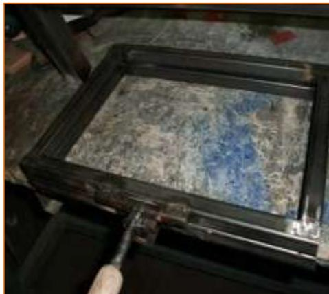
**Grafico32** Unión de estructura lateral, frontal y soporte de lámina
