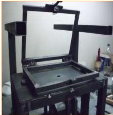
Una vez soldadas las estructuras procedemos a ensamblar las partes de los extremos con la parte delantera cuya dimensión es de 43cm x 30cm.
