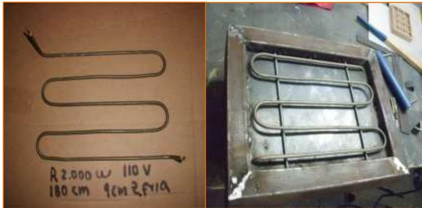
Esta es la resistencia de calentamiento la cual es controlada por un termostato que puede variar la temperatura desde 0°C hasta 350°C.
