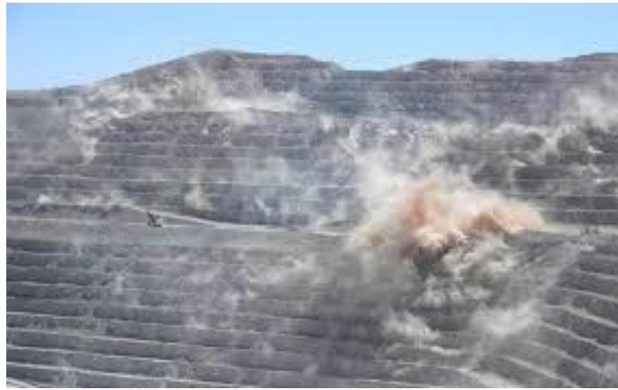
Figura 13 Voladura de rocas
