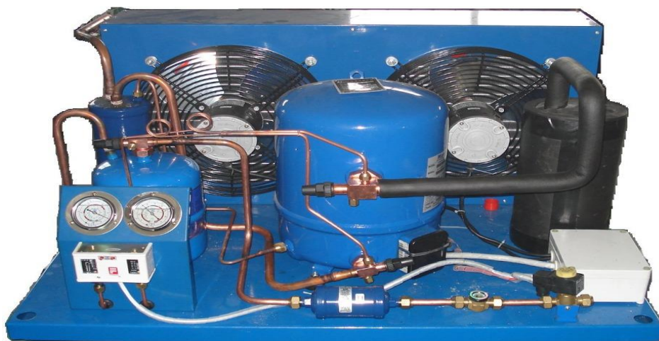
Figura 5. Unidad condensadora enfriada por aire (Universidad católica Santiago de Guayaquil)
