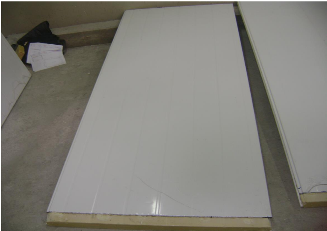
Figura 13. Paneles MAFRICO, para la construcción de las paredes y el techo de la cámara frigorífica UNEMI.
