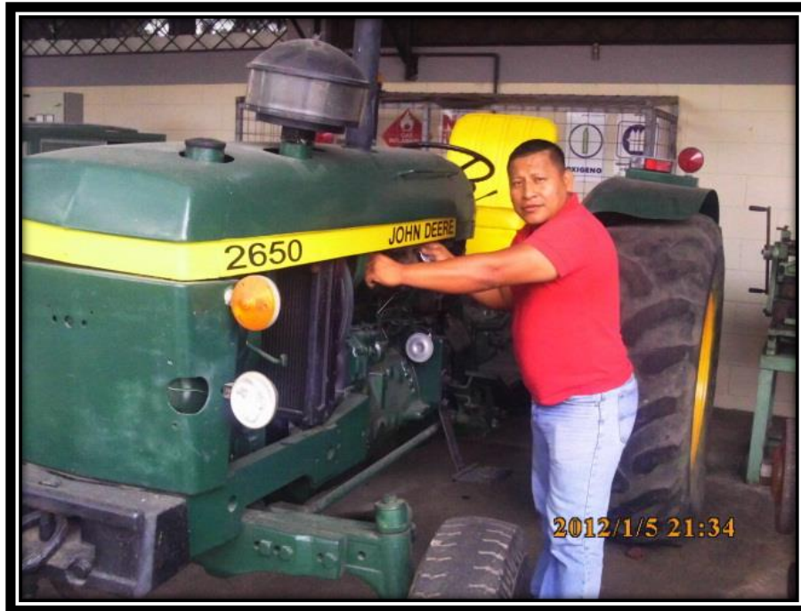
Instalación del enfriador de aceite
