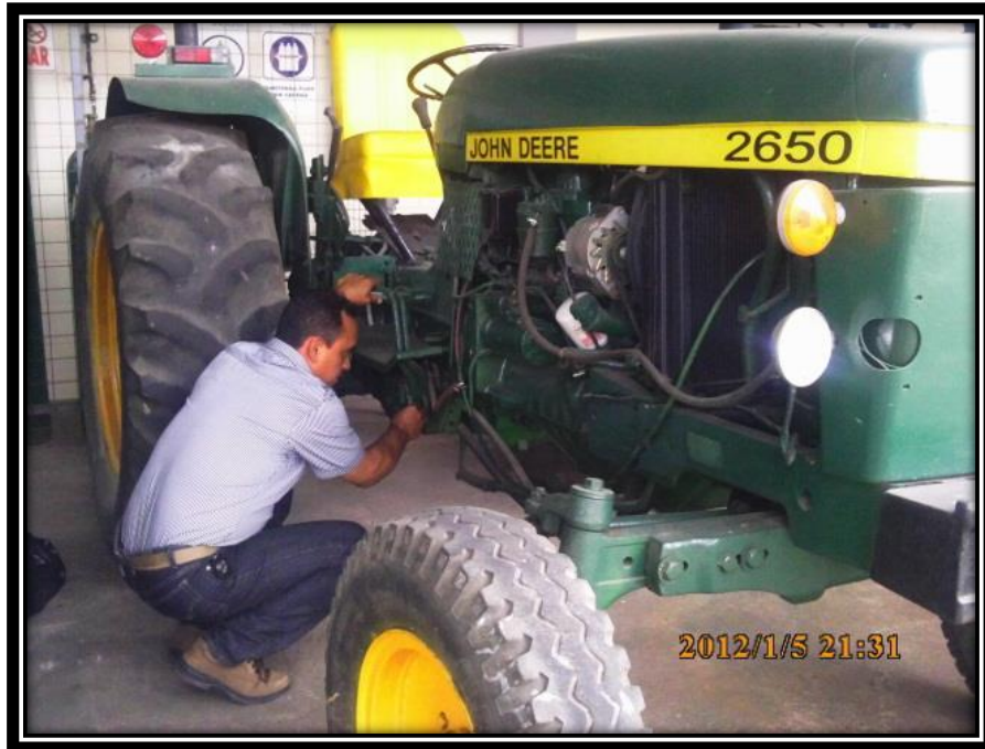
Limpieza del vástago del freno hidráulico
