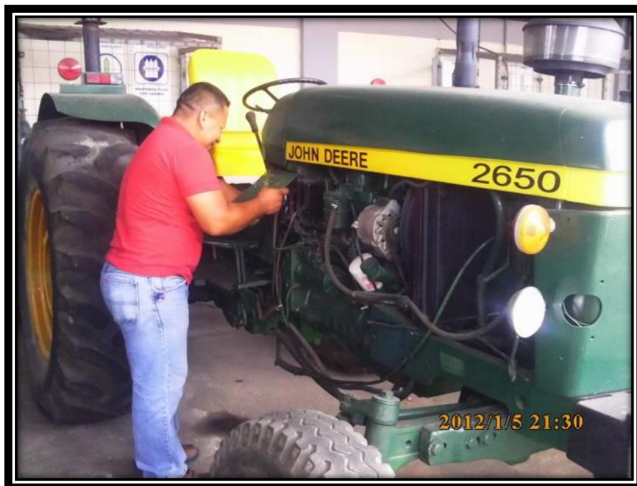
Conexión del manómetro medidor de presión hidráulica
