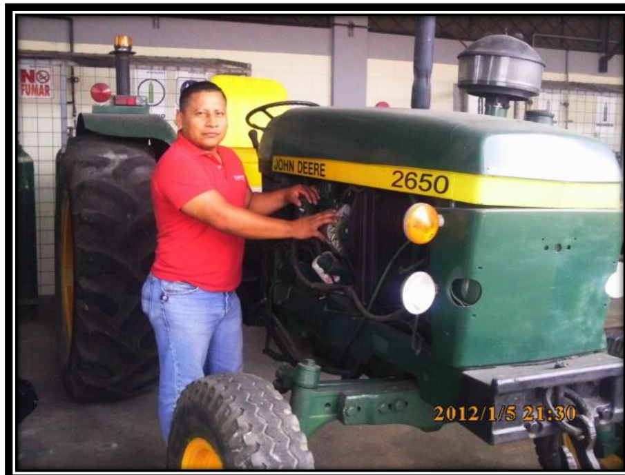
Inspección del nivel de aceite del depósito hidráulico
