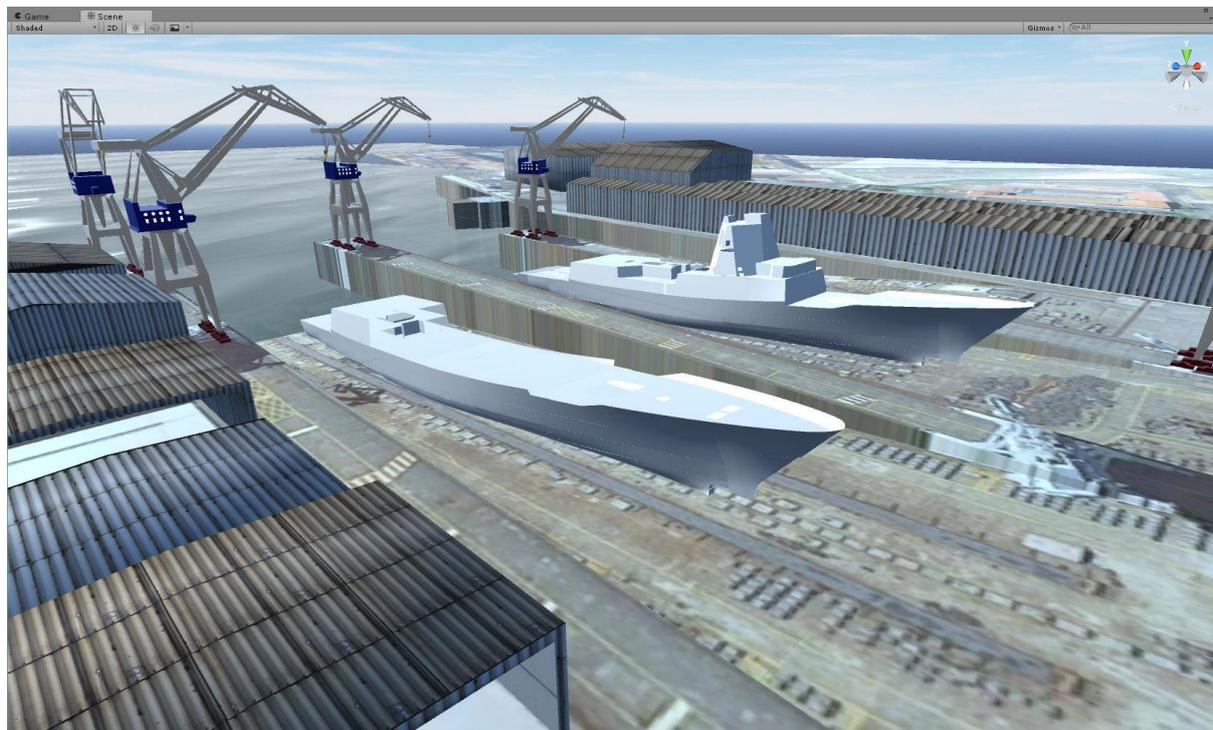
Figura 35. Actividad “Colocación en grada”, donde el barco se va construyendo según llegan los bloques. Fuente: elaboración propia.
