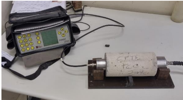
Figura 3.16 Ensaio de ultrassom nos corpos de prova de concreto.
