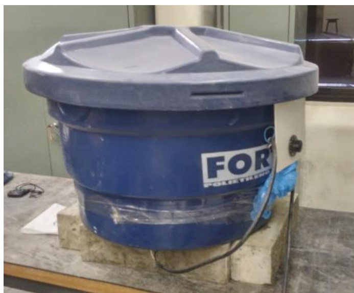
Figura 3.11 Caixa de água onde os corpos de prova foram submetidos à cura térmica.
