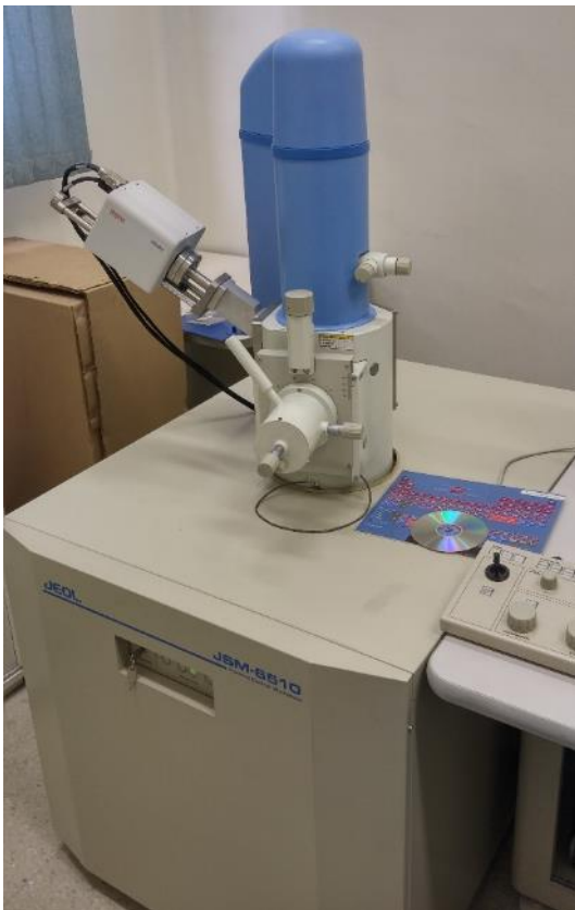
Figura 3.22 Microscópio Eletrônico de Varredura da Jeol, modelo JSM-6510.
