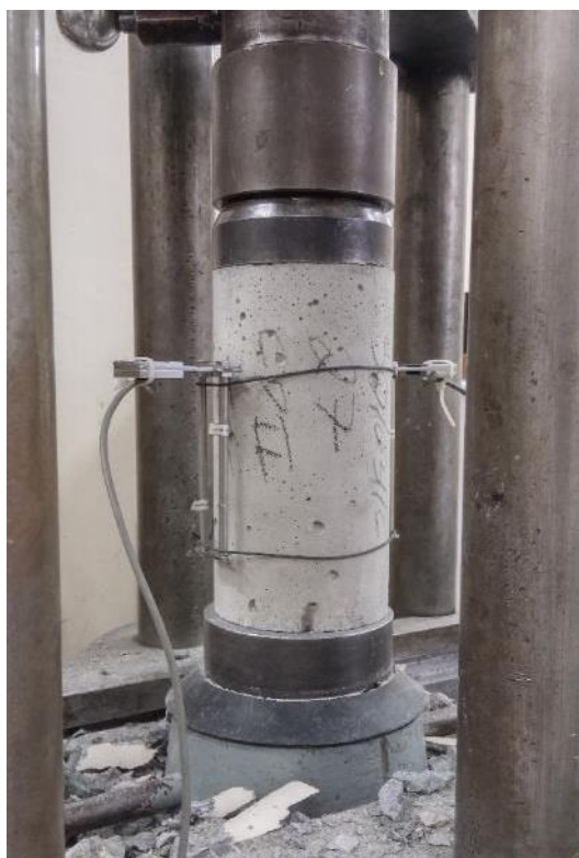
Figura 3.18 Detalhe dos extensômetros fixados juntos ao CP.
