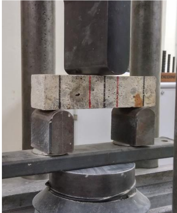
Figura 3.19 Detalhe do corpo de prova de argamassa na prensa para o ensaio.
