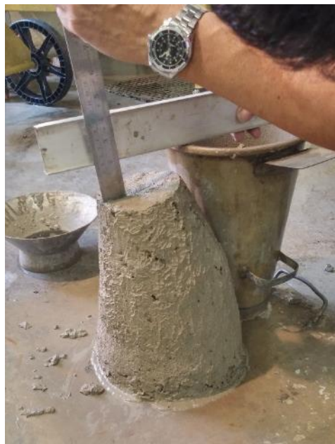
Figura 3.14 Medição do índice de consistência.
