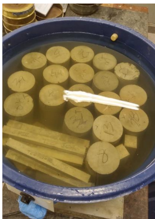
Figura 3.12 Corpos de prova submetidos à cura térmica em solução de \text{Na}_2\text{SO}_4 a 5%.
