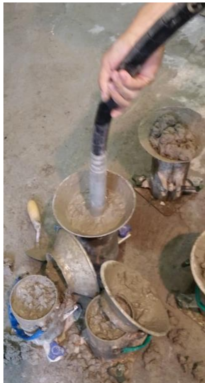
Figura 3.6 Corpos de prova de concreto sendo moldados e vibrados.
