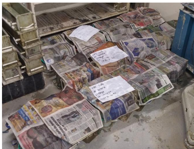
Figura 3.7 Corpos de prova cobertos para evitar a evaporação da água de hidratação.
