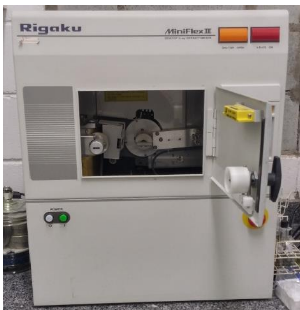
Figura 3.24 Aparelho de DRX da Rigaku, modelo MiniFlex II.
