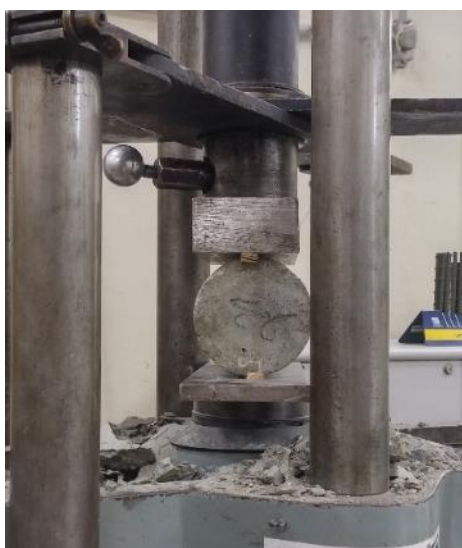
Figura 3.21 Corpos de prova de concreto sendo ensaiados à tração por compressão diametral.
