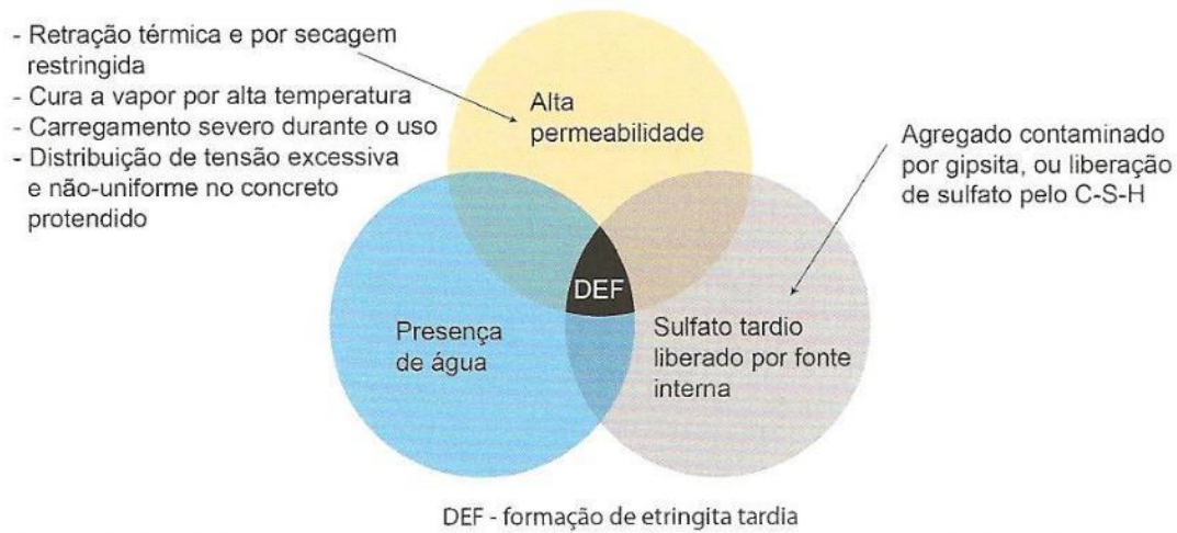
Figura 2.1 Enfoque holístico para expansão e fissuração por formação de etringita tardia.
