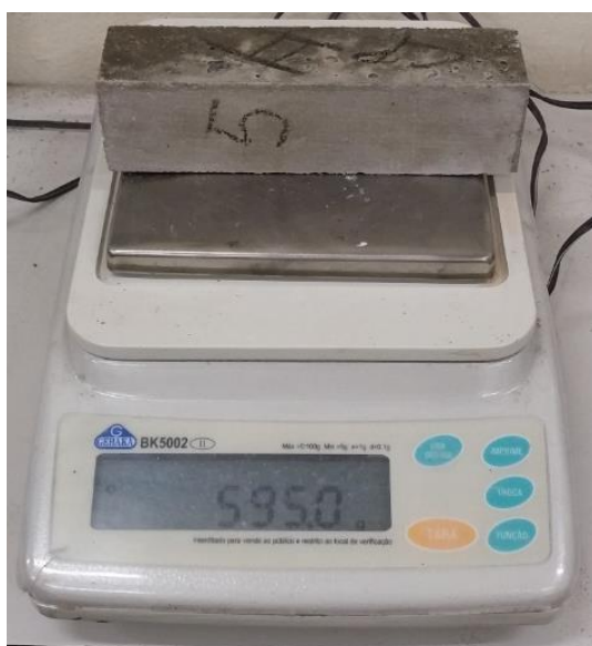
Figura 3.9 Corpos de prova sendo pesados na balança da Gehaka, modelo BK5002 classe II.
