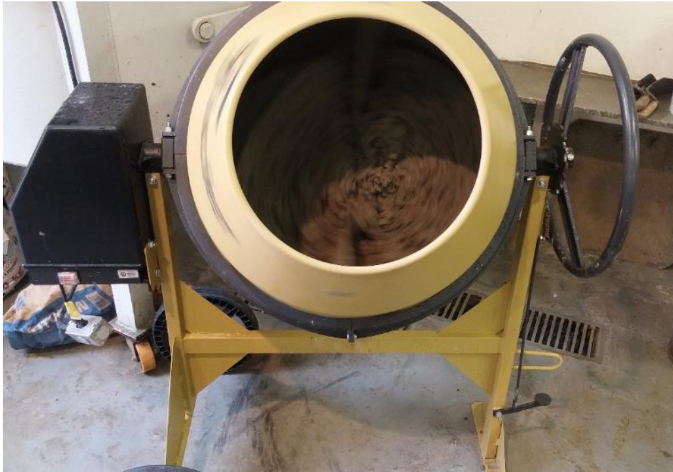
Figura 3.5 Mistura dos materiais na betoneira estacionária de eixo inclinado.
