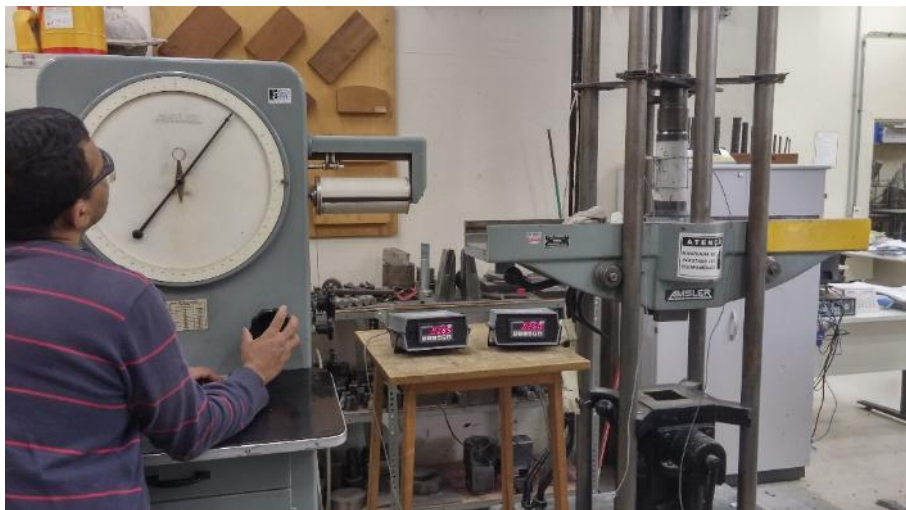
Figura 3.17 Ensaio para a obtenção do módulo de elasticidade do concreto.
