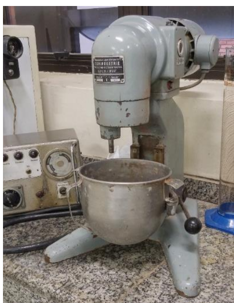
Figura 3.4 Argamassadeira utilizada para o preparo da pasta de cimento e da argamassa
