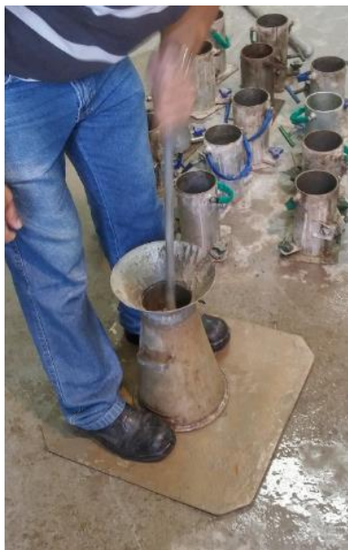
Figura 3.13 Moldagem do tronco de cone para a realização do ensaio de consistência.
