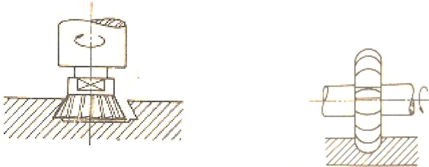
Figura 9 - Casos especiais de fresagem cilíndrica tangencial (Ferraresi, 1977).
