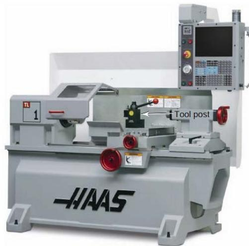
Figura 39 - Torno CNC (Hoffman *et al.*, 2011).
