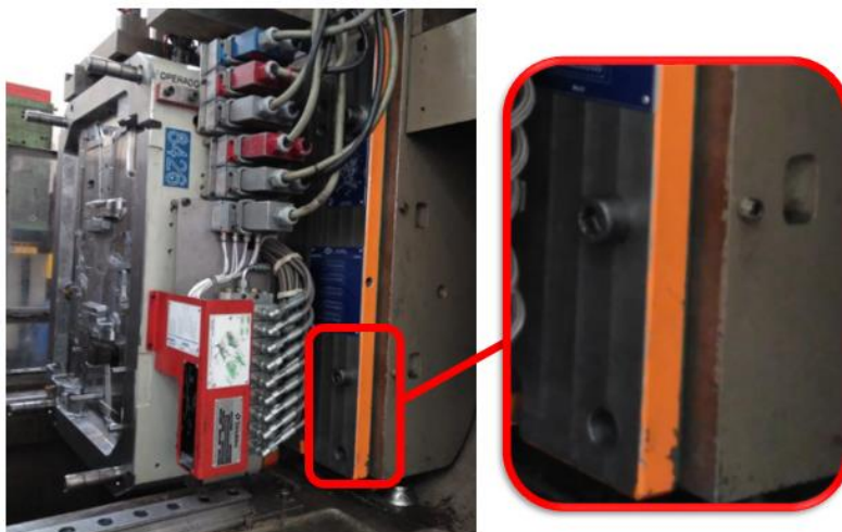
Figura 10 - Aperto direto do molde à máquina de injeção
