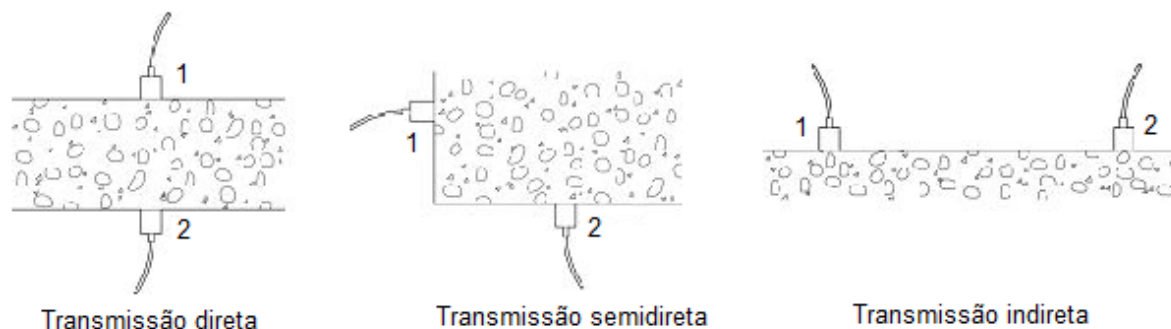
Figura 3.51 - Métodos de transmissão no ensaio de ultrassons [27].
