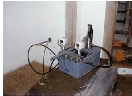
b) Aplicação dilatômetro em parede.
