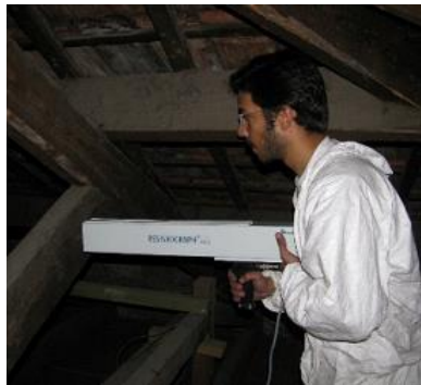
Figura 3.59 - Medição integridade de elementos de madeira com o Resistógrafo [112].
