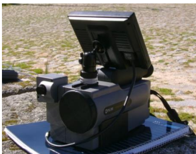
a) Câmara termográfica.
