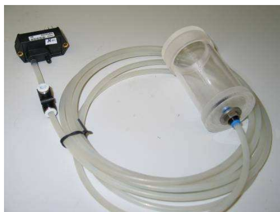
Fig 5- Sensor de pressão, respectivo tubo e reservatório para medição de desníveis.
