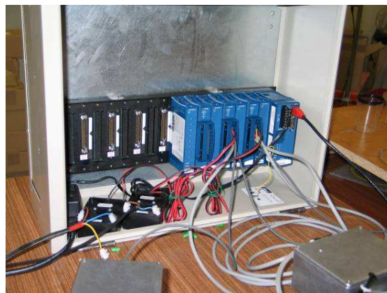
Fig 23- Sistema de aquisição NI-FieldPoint para sensores de base eléctrica em fase definitiva.
