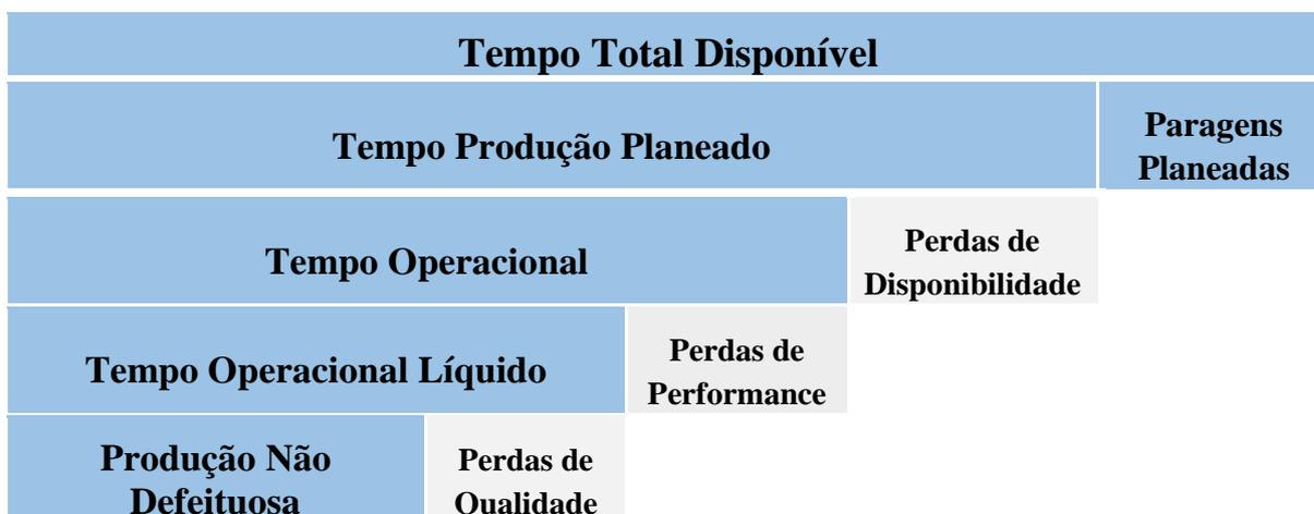
Figura 3 - Tempo utilizados para o cálculo do *OEE*
