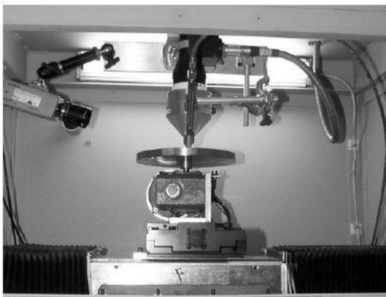
Figura 71 – Exemplo de sistema de controlo das temperaturas geradas no processo de Laser Cladding; retirado de [13]
