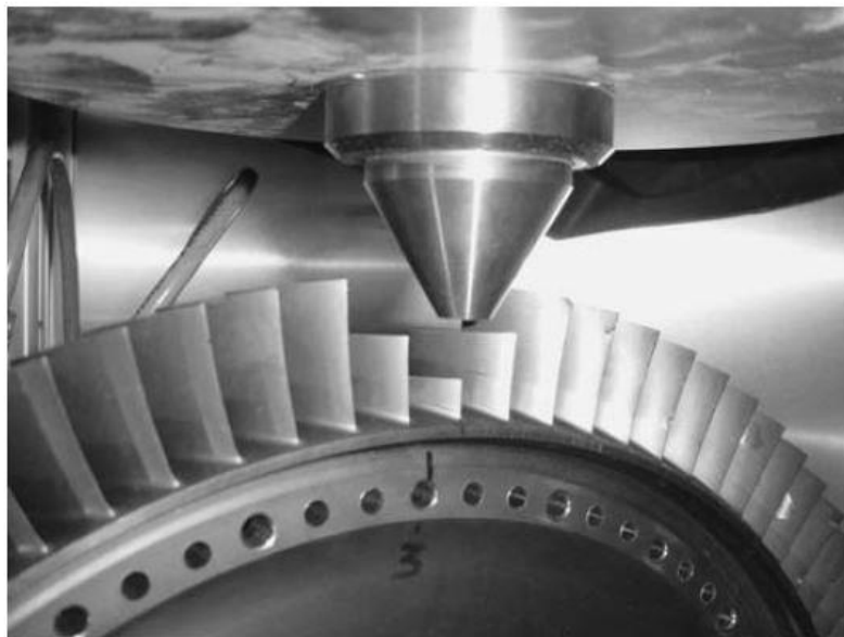
Figura 26 - Exemplo de reparação de uma turbina pelo processo de Laser Cladding; retirado de [34]
