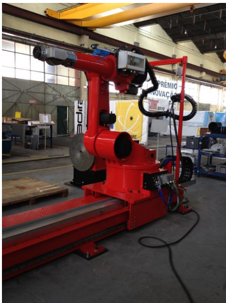
Figura 78 - Robô de seis eixos Reis RV60-40, com pormenor ampliado da flange de ligação
