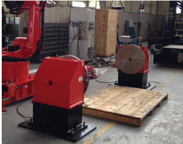
Figura 79 - Módulos periféricos Reis RDM11
