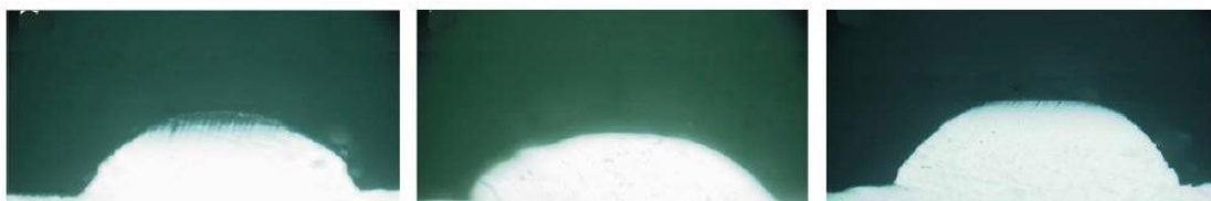
Figura 57 - Influência da densidade energética do laser (relação potência – velocidade de varrimento) na altura do revestimento; adaptada de [31]
