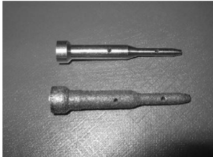
Figura 23 - Fabrico de um implante de titânio, pelo processo de Laser Cladding (antes e depois do tratamento de acabamento superficial); retirada de [17]
