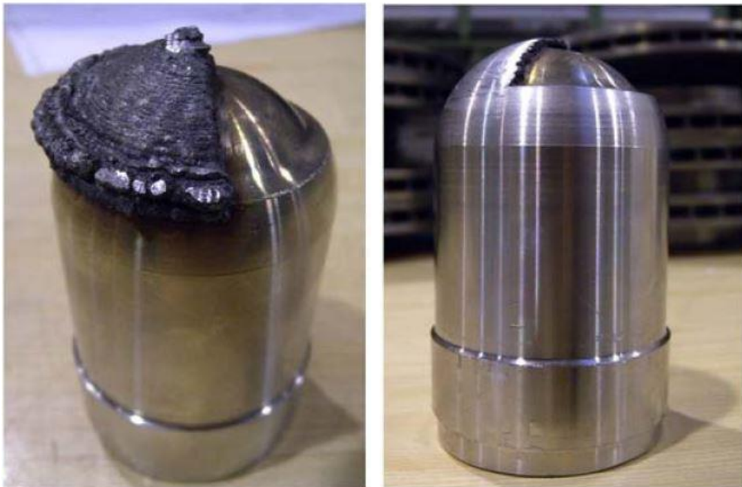
Figura 69 – Exemplo de componente produzido com uma incorreta aplicação dos parâmetros de processamento, antes e depois do tratamento de acabamento; retirado de [25]
