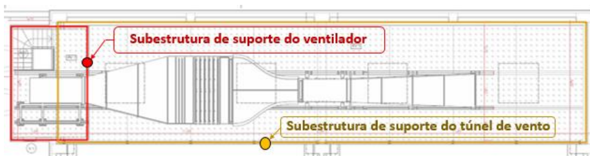
Fig. 58 – Localização em planta das duas subestruturas.
