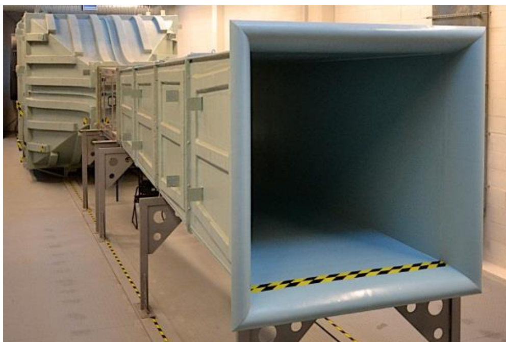
Fig. 54 – Vista geral do túnel de vento
