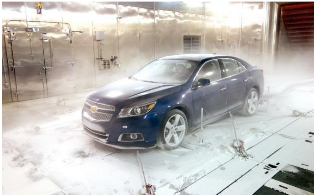
Fig. 6 – Chevrolet durante um ensaio climatérico.
