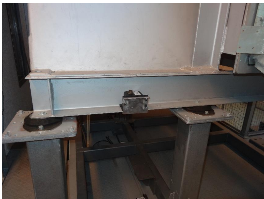
Fig. 71 – Localização do acelerômetro A1, antes dos apoios em neopreno.
