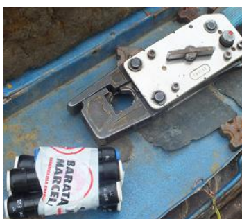
Figura 3.8 - Alicates para Cravar Uniões + Uniões 70 e 95mm 2
