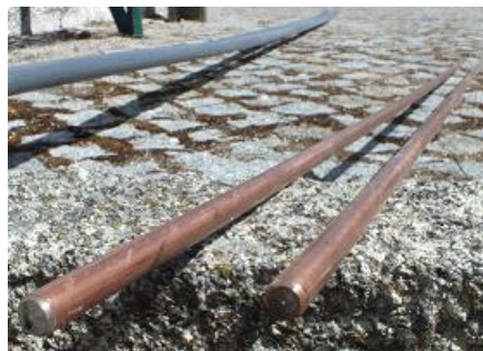
Figura 3.12 - Vareta de Aço forrada a Cobre + Tubo PVC de 25mm
