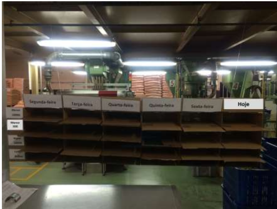
Figura 28 - Caixa de nivelamento de ordens de fabrico
