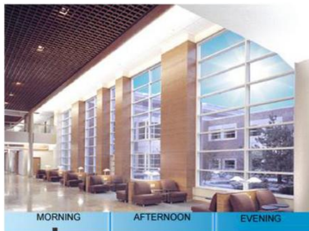
Figura 3.5 - Coloração transparente em vidros fotocromáticos nas primeiras horas do dia [38]
