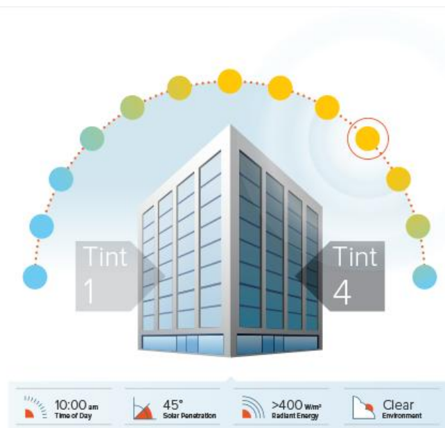
Figura 3.27 - Nível de escurecimento do vidro electrocrómico ao fim do dia [16]
