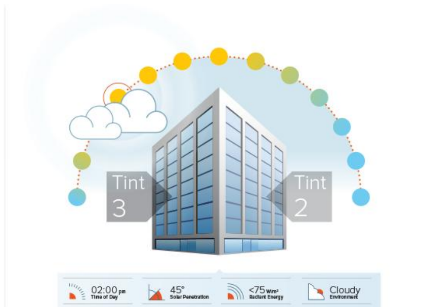
Figura 3.28 - Nível de escurecimento do vidro electrocrómico ao início do dia com nebulosidade [16]
