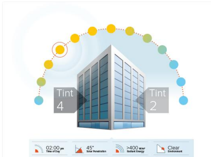
Figura 3.26 - Nível de escurecimento do vidro electrocrómico ao início do dia [16]
