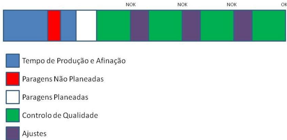
Figura 34 – Diagrama temporal do processo de produção
