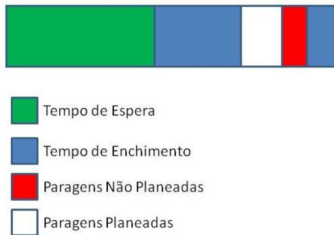
Figura 35 – Diagrama temporal do processo de enchimento
