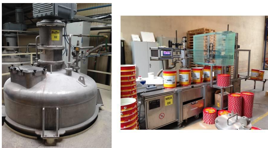
Figura 17 - Buffer e mesa de enchimento da "MD500"
