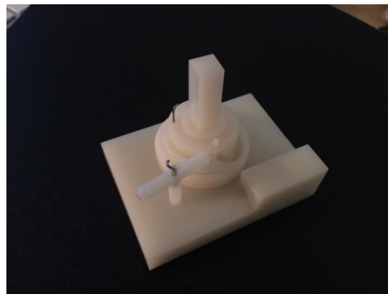
Figura 50 -Protótipo em SLA do conceito A2
