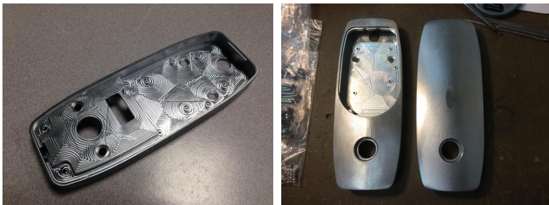
Figura 116 – Primeira base já maquinada (esquerda) e tampas maquinadas (direita)
