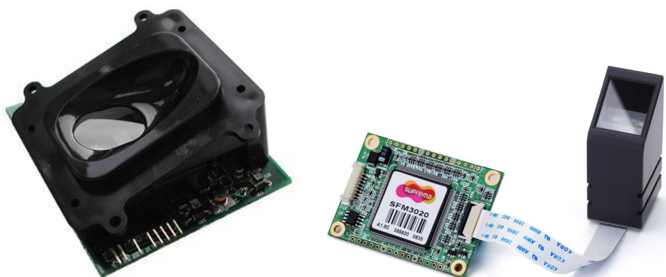
Figura 16 - Alguns módulos OEM com dispositivos de reconhecimento da impressão digital [6], [7]
