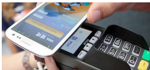
Figura 23 - Pagamento com telemóvel por NFC [19]
