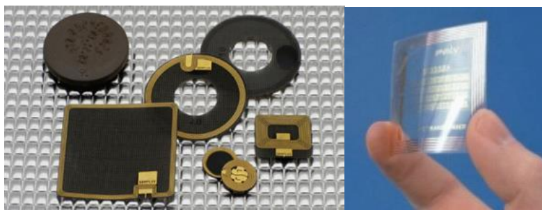
Figura 10 - Tags Activas (à esquerda) e Tags Passivas (à direita).
