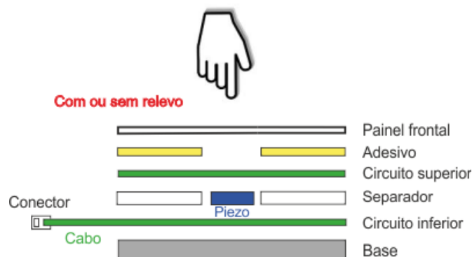
Figura 6 - Figura-exemplo do funcionamento de um teclado piezoelétrico [1]
