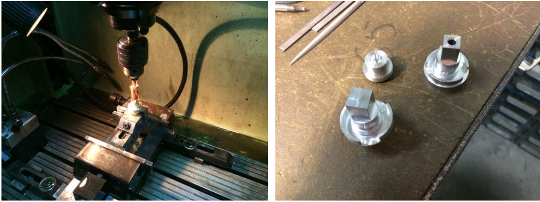
Figura 117 - Erosão dos furos (esquerda) e os 3 tipos de zarelhos já finalizados (direita)
