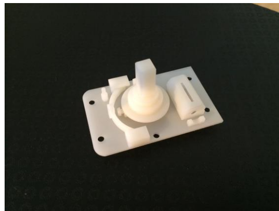
Figura 57 - Protótipo em SLA do conceito A4
