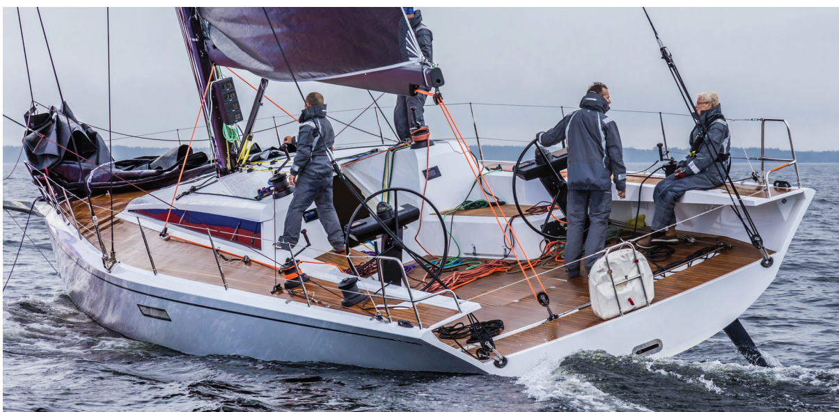
Fig 12. Clubswan 50 - Ao baixar a mudança de rumo junto da popa, os convés laterais transformam-se nos assentos do cockpit nas traseiras ainda tendo um assento separado mais próximo da gaiuta de escotilha.
