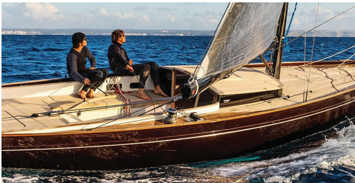
Fig 16. Wallynano por Wally e Andre Hoek design - Tem um tecto da cabine levantado e corre as escotas em torno dele. Como nos Wallys maiores, as escotas estão escondidas sob o piso do convés, tanto para segurança quanto para razões estéticas.
