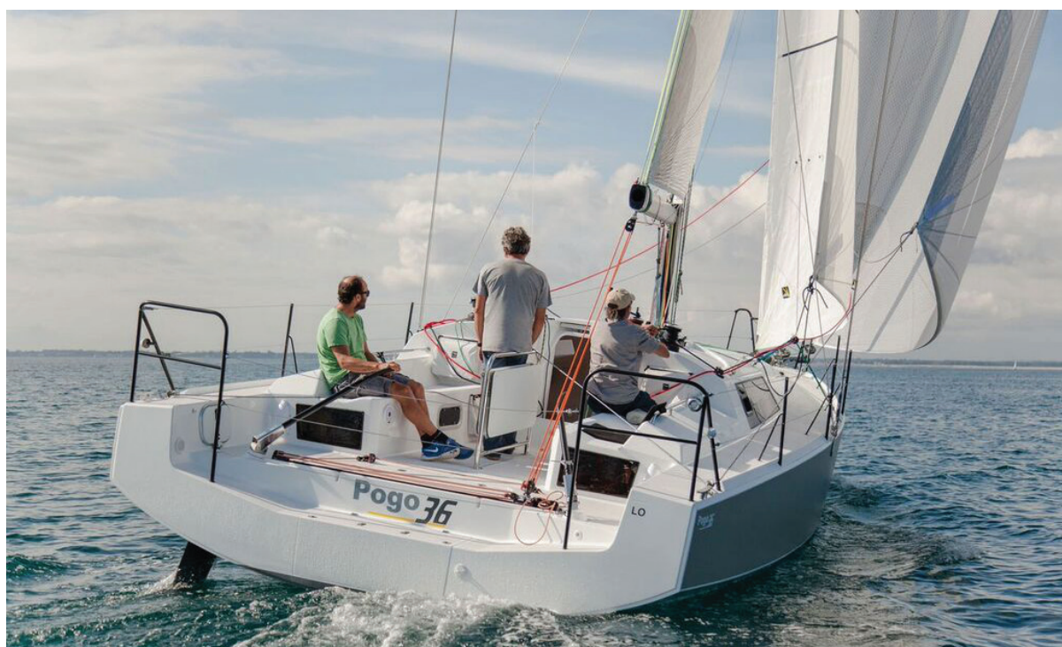
Fig 14. Pogo 36 – Canas do leme gêmeas conectadas a lemes gêmeos – As canas do leme deste Pogo 36 estão localizadas atrás de cada um dos assentos do cockpit que não alcançam todo o caminho de volta à popa arrasada, deixando a retaguarda muito aberta e o chão do cockpit livre.
