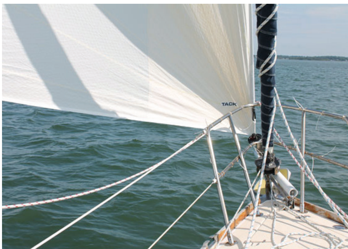
Fig 19. Os fios de guarda que seguem através de e suportados pelos balaústres estão conectados ao guarda proeiro na proa, onde a estrutura de segurança é maior.
