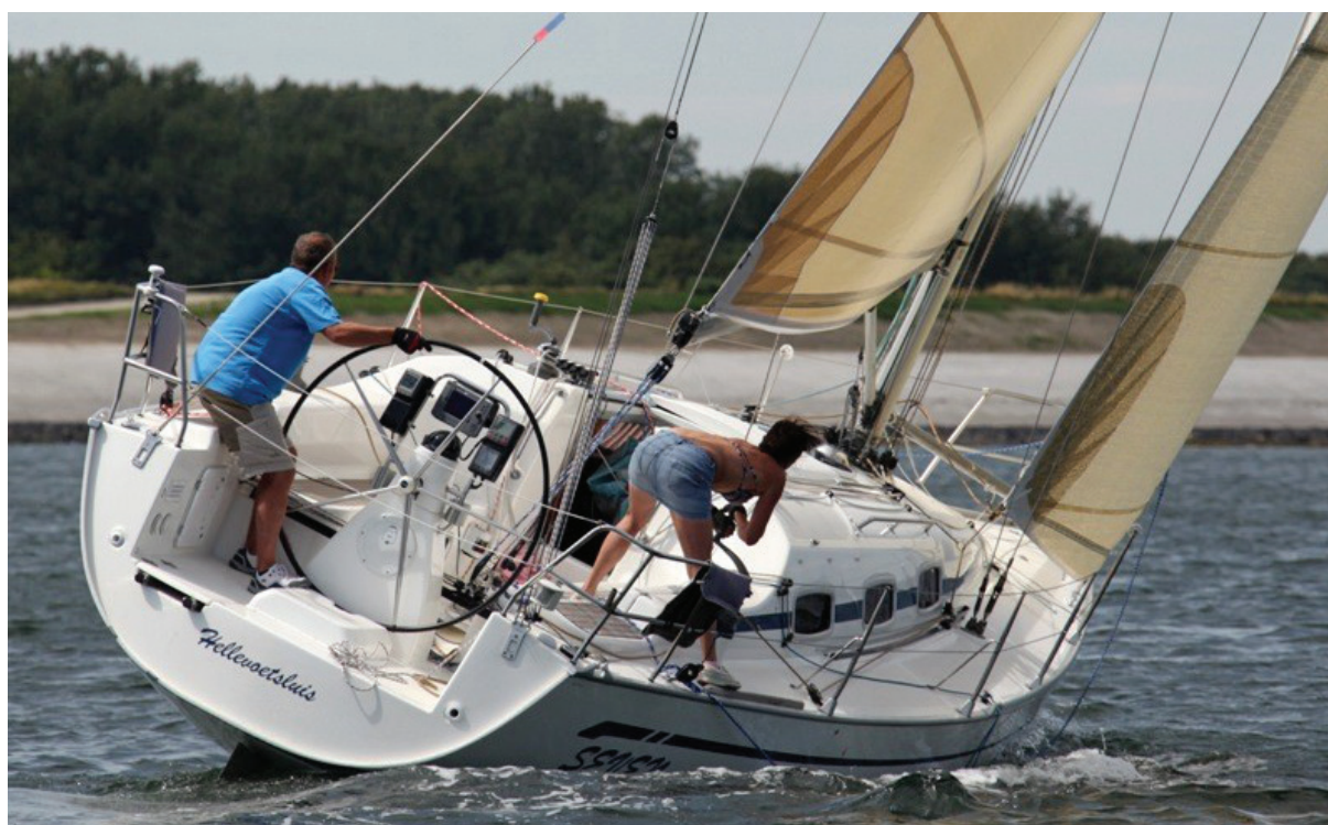
Fig 13. Bavaria 35 Match – A roda tem de ser alcançada a partir dos assentos de piloto, nas partes mais a popa dos convés laterais, resultando numa roda muito grande e o encerramento da popa arrasada desde o cockpit.
