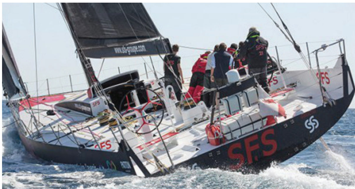
Fig 10. Volvo Ocean 70 - Team SFS - Embora seja também um barco muito longo e largo, o único passo do cockpit ao convés faz o cockpit menos isolado dos convés laterais e da proa.
