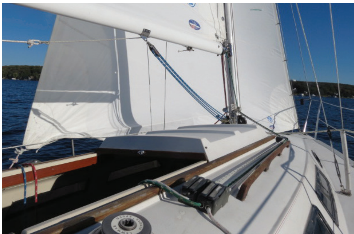
Fig 15. Escotas que são controladas do cockpit. O setup mais usado é aquele que consiste nas escotas que correm desde o mastro a popa, por cima do tecto da cabine e seguras pelos mordetes para escota e por guinchos em cada lado da gaiuta de escotilha.
