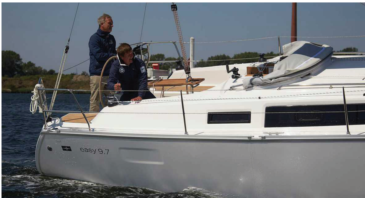
Fig 3. Bavaria Easy 9.7 - Os lados do tecto da cabine se estendem de volta ao cockpit, formando encostos para os assentos e aumentam a altura do tecto na cabine e na casa de banho.
