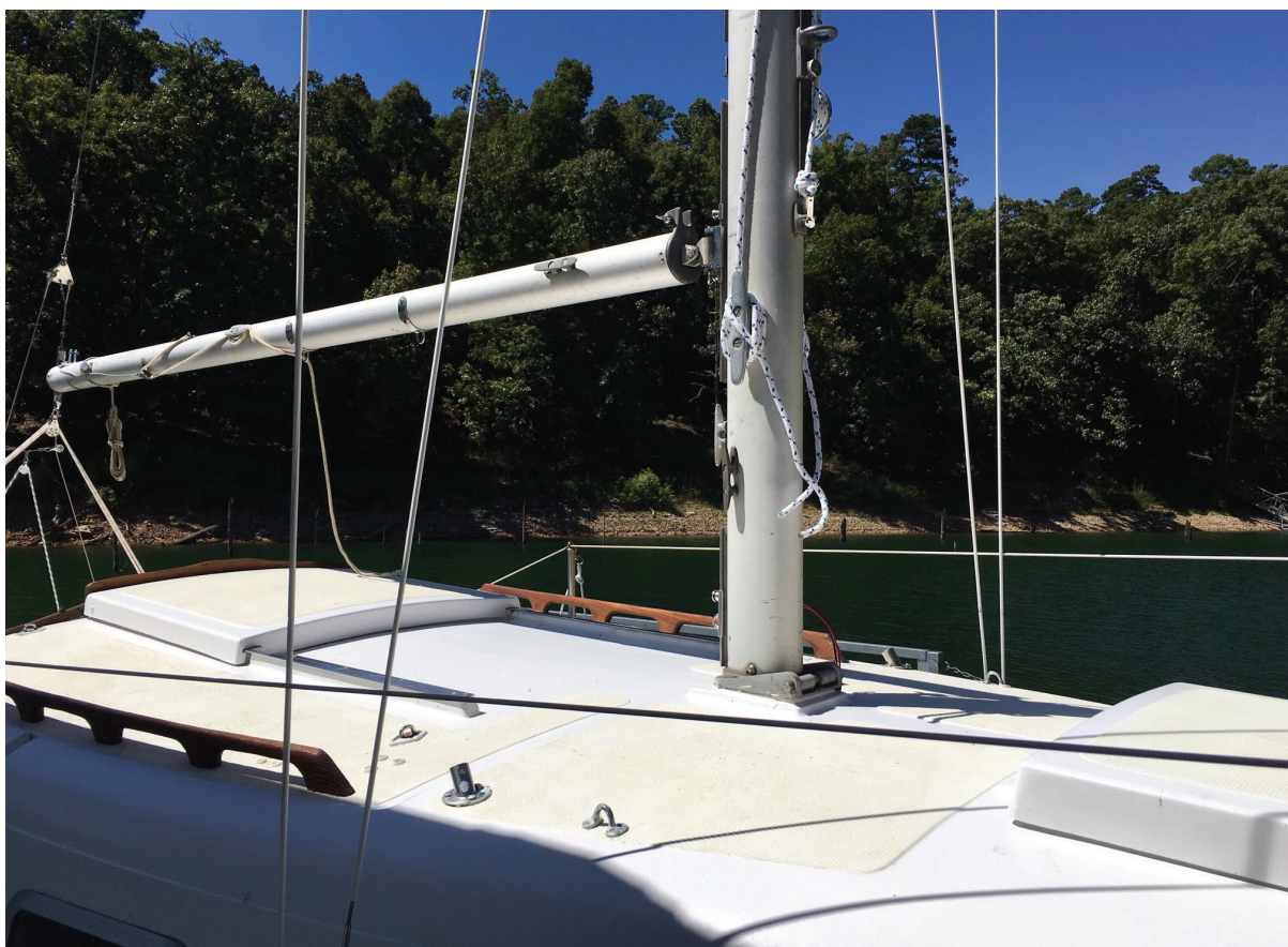
Fig 17. A enxárcia exterior ou a enxárcia de topo e a enxárcia inferior encontram-se na sua base onde são presas ao casco.
