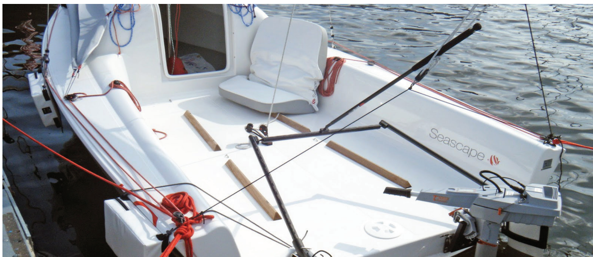
Fig 11. Seascape 18 – Suportes de esteira de madeira presos ao chão do cockpit para reforço contra a gravidade enquanto durante inclinação.
