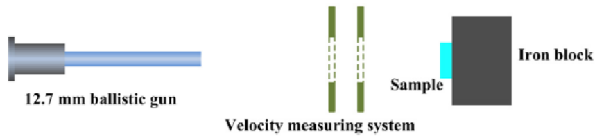
Figura 3.6: Diagrama esquemático de uma montagem típica de ensaios balísticos [53]
