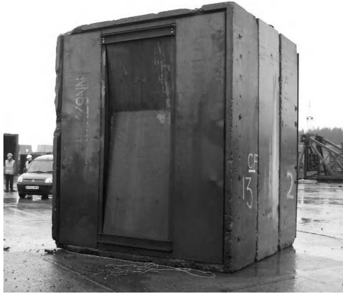
Figura 2.12 Painel de UHPFRC depois de ter sido testado [59].
