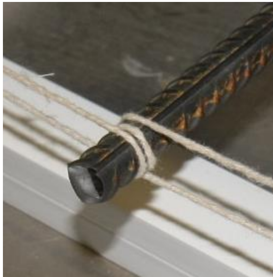
Figura 4.6 Pormenor de um varão enrolado com duas voltas pelo cordão de suspensão.
