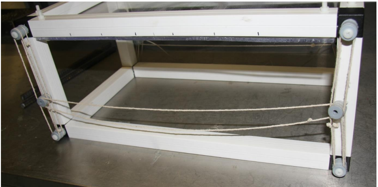
Figura 4.4 Colocação do cordão central que irá suspender os varões. O cordão tem bastante folga para compensar o comprimento que será enrolado em torno de varões de diâmetro maior.
