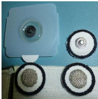
Figura 9 - El ttodo t xtil utilizado no sistema vest vel desenvolvido no projeto SIVIC (em baixo), el ttodo convencional em cima
