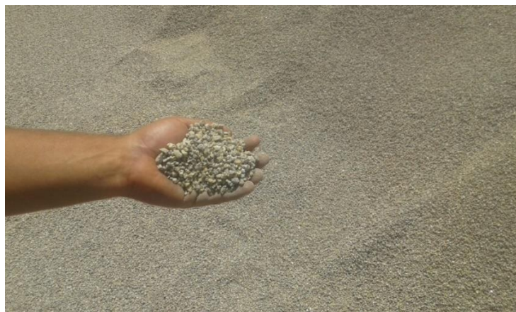
Figura 2.3 – Areão em estaleiro.
