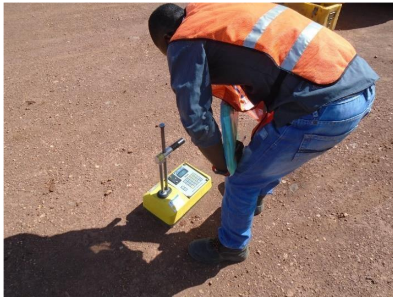
Figura 2.1 – Ajudante de Laboratório a utilizar gama densímetro em aterro.
