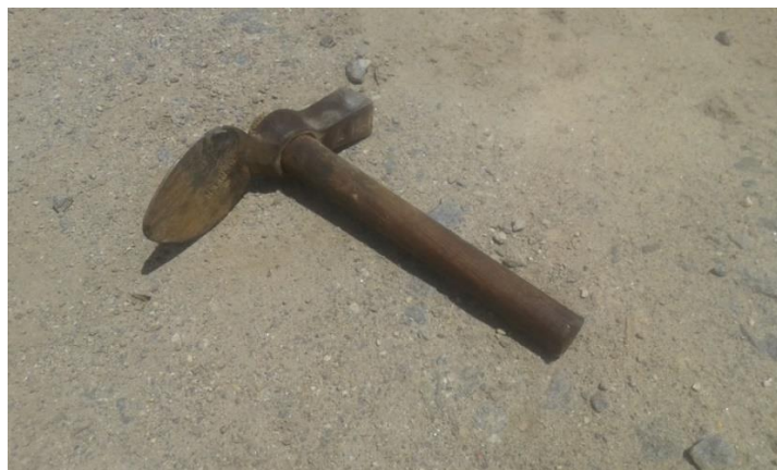
Figura 2.21 - Martelo usado pelo calceteiro.
