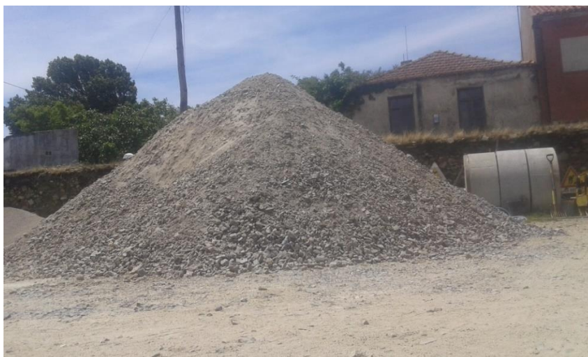
Figura 2.2 – Material de granulometria extensa em estaleiro.
