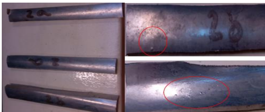
Figura 58 - Aspeto superficial dos provetes obtidos a partir da peça 2 após o tratamento de homogeneização
