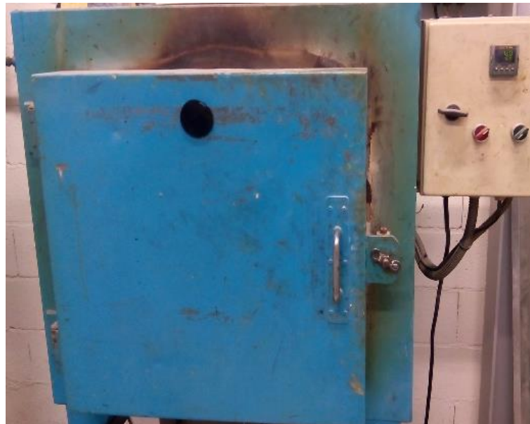
Figura 31 - Forno de convecção forçada utilizada para a realização dos envelhecimentos
