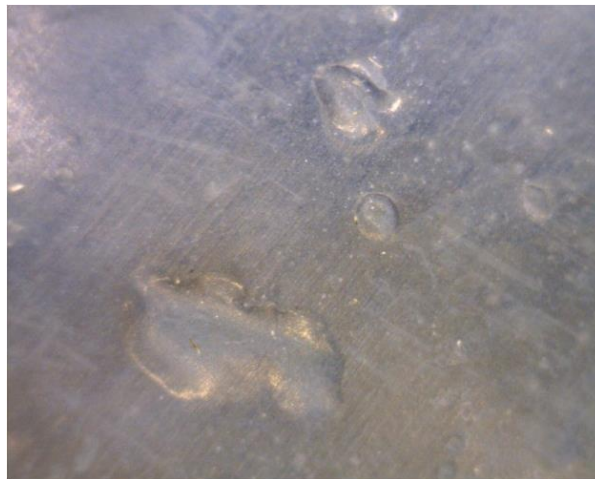
Figura 17 - Peça com bolhas superficiais[44]
