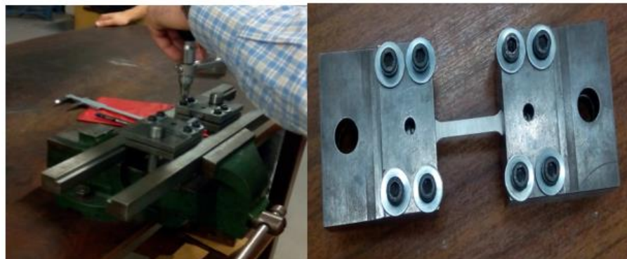
Figura 35 - Montagem dos provetes nas amarras
