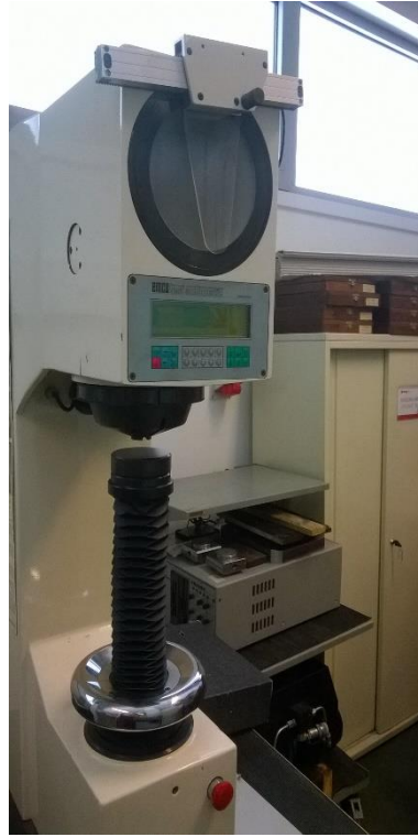
Figura 32 - Durómetro EMCO M4U – 075 utilizada para a medição das durezas
