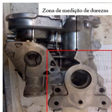
Figura 47 - Zona de medição de durezas
