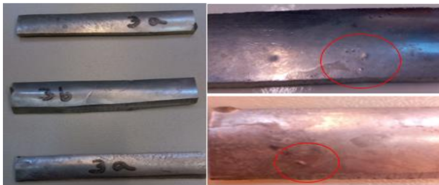
Figura 57 - Aspeto superficial dos provetes obtidos a partir da peça 3 após o tratamento de homogeneização
