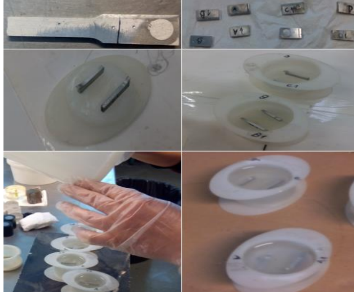
Figura 37 - Corte e montagem dos provetes em resina
