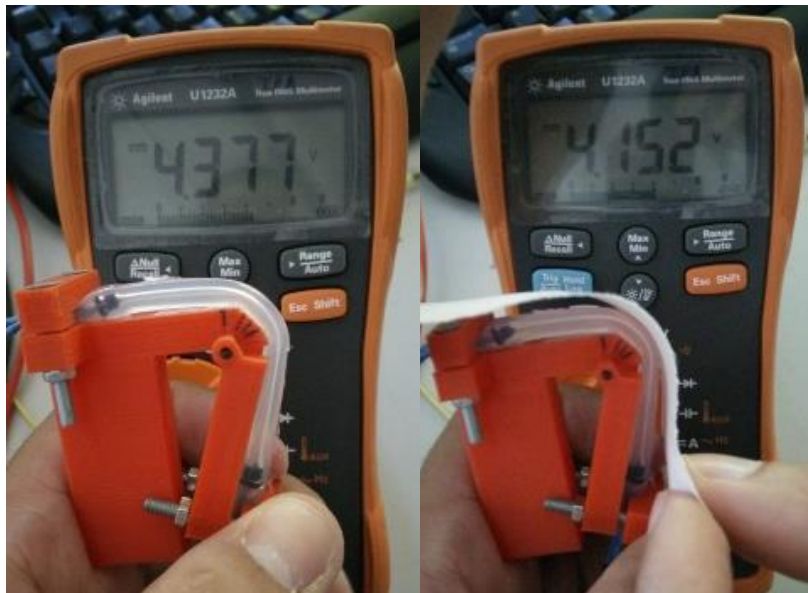
Figura 3.16: Protótipo de sensor em teste, sem papel branco (à esquerda) e com papel branco (à direita)
