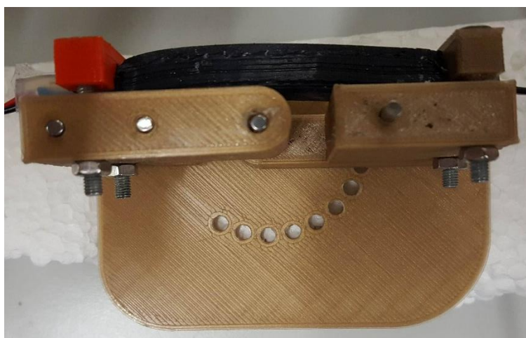
Figura 3.14: Teste de sensor, na posição de flexão de zero graus
