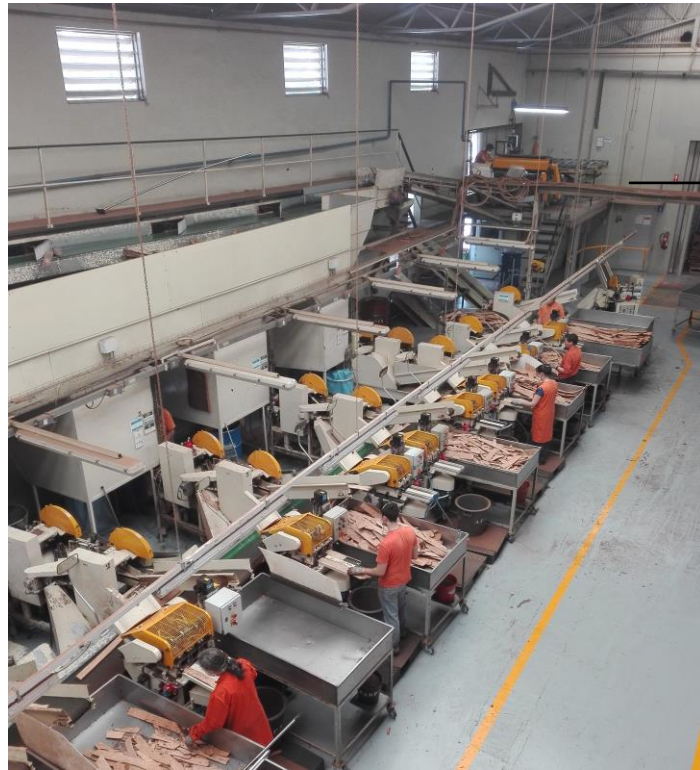
Ilustração 21 - Centro de Trabalho: Fabricação de Discos
