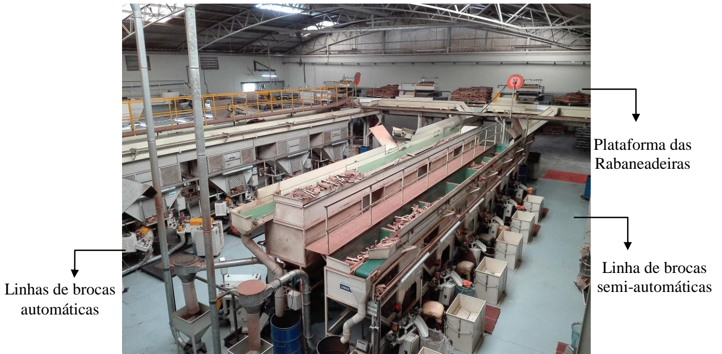
Ilustração 18 - Centro de trabalho: Fabricação de Rolhas
