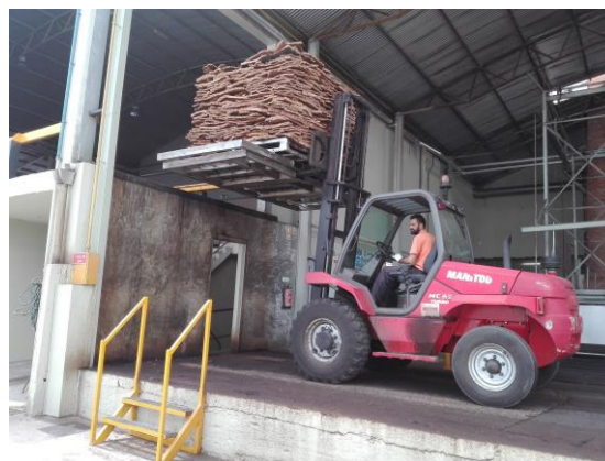
Ilustração 26 - Elevação de paletes para piso superior
