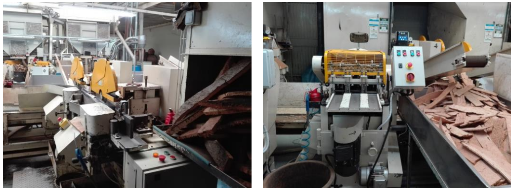
Ilustração 22 - Laminadeiras e Traços de Cortiça
