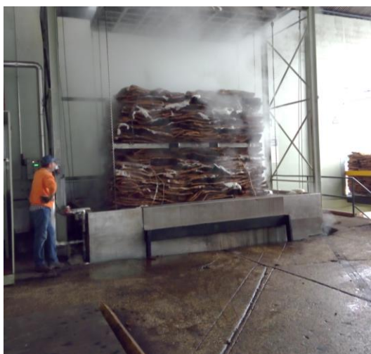
Ilustração 14 - Caldeira terminando o seu processo de cozedura
