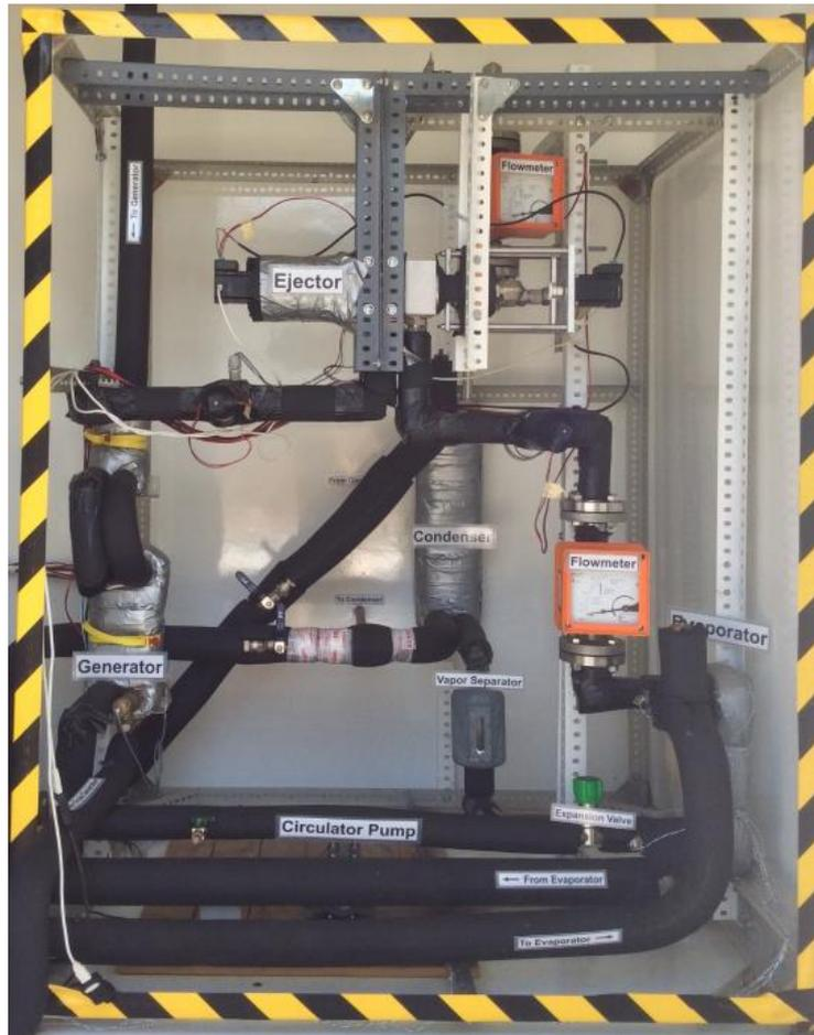
Figura 3.6 – Ciclo de ejeção da instalação SOLAR-TDF, com identificação dos componentes principais [48].
