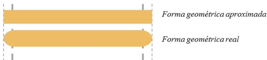
Figura 13 – Comparação da geometria real com a considerada para efeitos práticos
