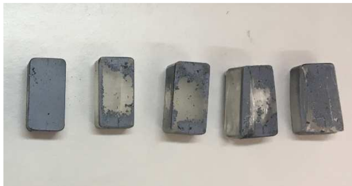
Figura 4.5 – Apresentação dos provetes usados nos ensaios de compressão da resina Sikadur-52®
