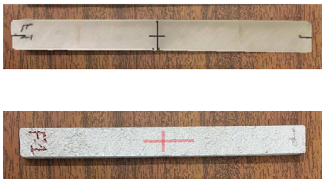
Figura 3.27 – Linhas médias traçadas nos provetes de resina Sikadur-52® e Sikadur-30®
