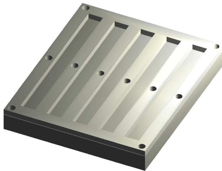
Figura 3.4 – Projeto em 3D do molde a ser usado na fabricação dos provetes de flexão segundo a norma ASTM D790
