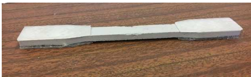
Figura 3.14 – Aplicação de chapas acrílicas na zona de amarração dos provetes
