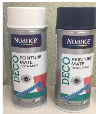
Figura 3.28 – Tintas a que se recorre para criar um padrão speckle
