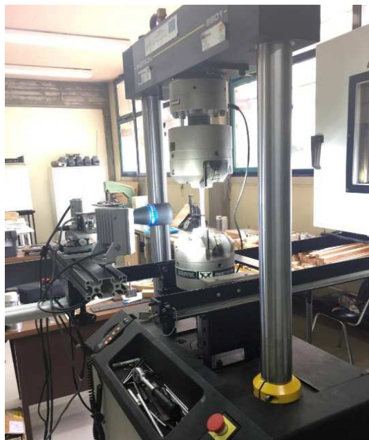
Figura 3.18 – Sistema de correlação digital de imagem: ensaio à tração
