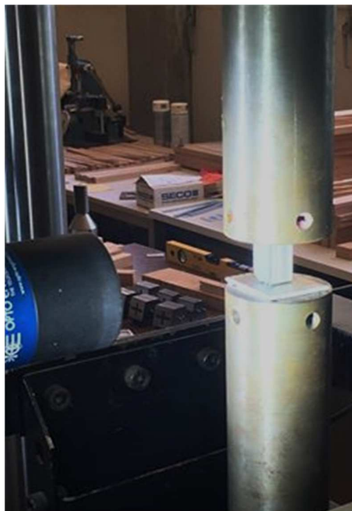
Figura 3.22 – Sistema de correlação digital de imagem: ensaio à compressão
