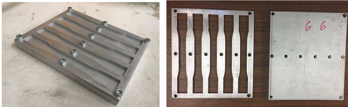
Figura 3.9 – Fotografia dos moldes a utilizar na fabricação dos provetes de tração e fadiga segundo as normas ASTM D638 e ASTM D7791-12
