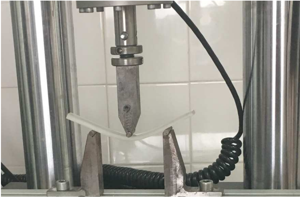
Figura 4.14 – Término do ensaio à flexão após grande deformação do provete
