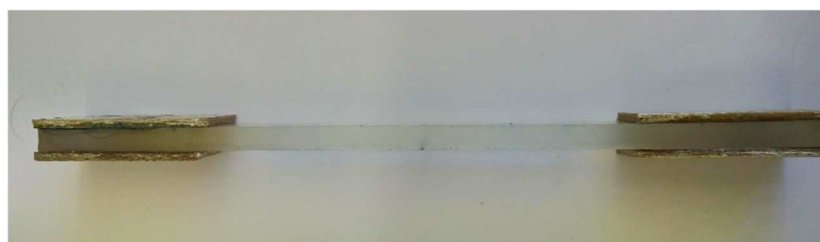
Figura 3.34 – Aplicação de placas metálicas em provetes Sikadur-52®
