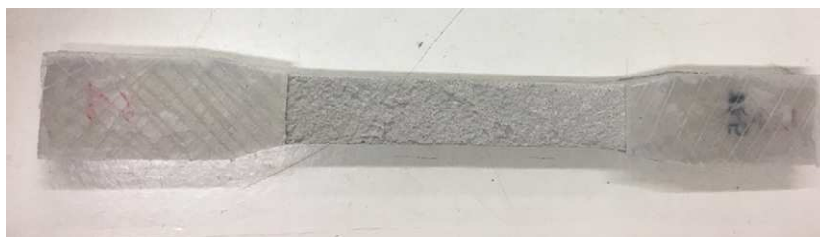
Figura 3.33 – Aplicação de placas acrílicas em provetes Sikadur-30®
