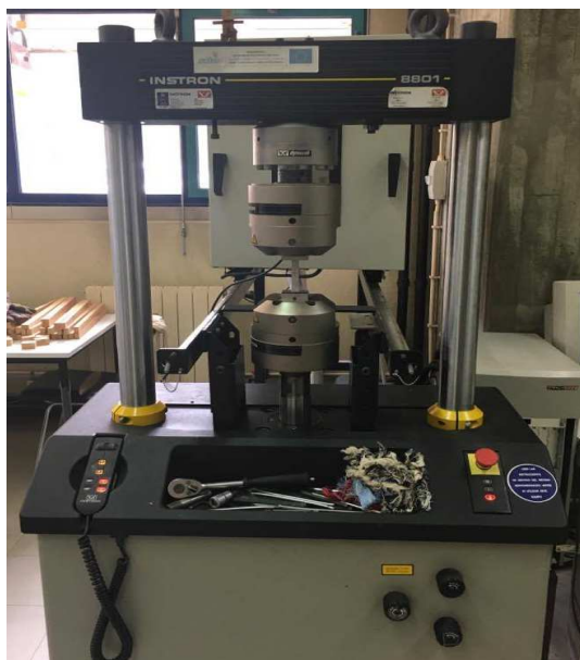
Figura 3.35 – Máquina de ensaio INSTRON 8801: ensaio à fadiga
