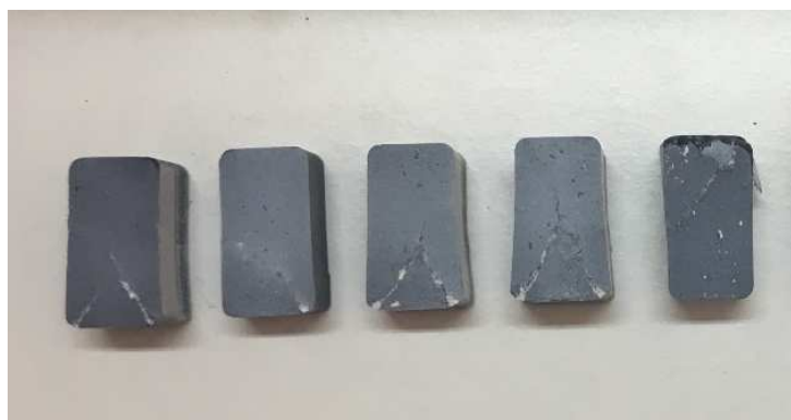
Figura 4.6 – Apresentação dos provetes usados nos ensaios de compressão da resina Sikadur-30®
