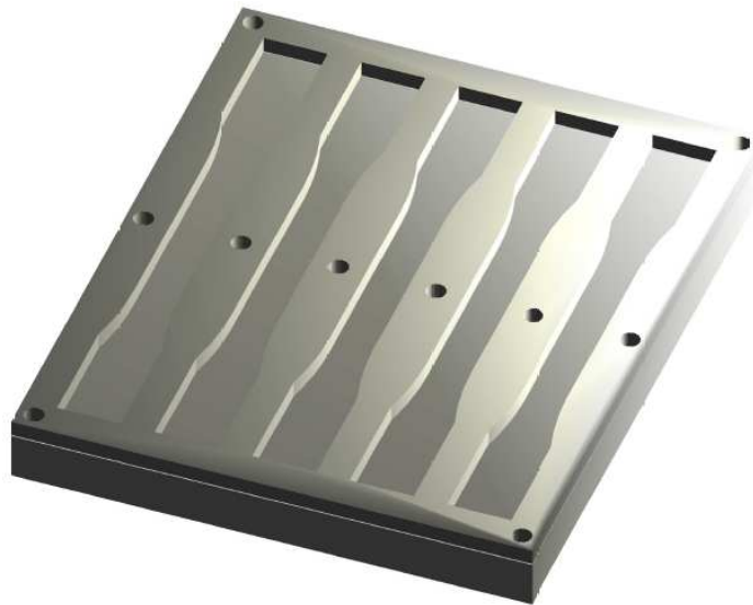
Figura 3.6 – Projeto em 3D do molde a ser usado na fabricação dos provetes de tração e fadiga segundo as normas ASTM D638 e ASTM D7791-12
