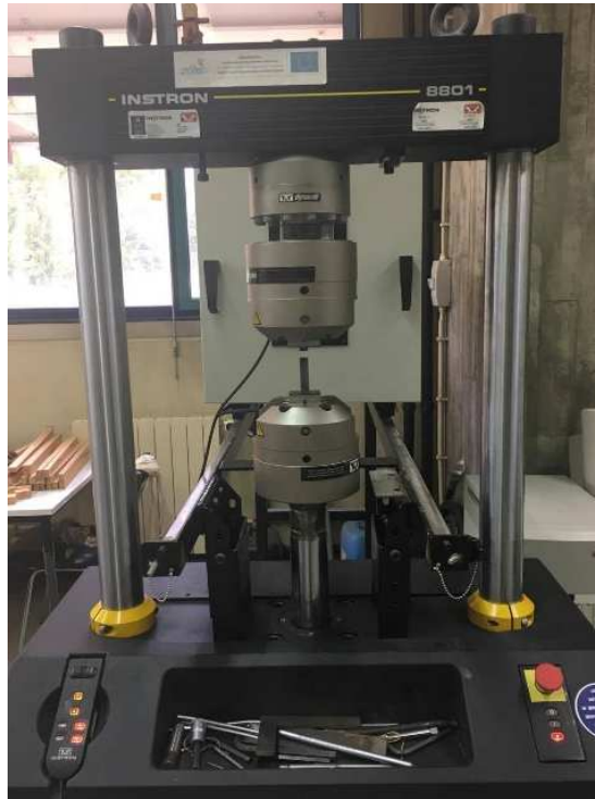
Figura 3.17 – Máquina de ensaio INSTRON 8801: ensaio à tração
