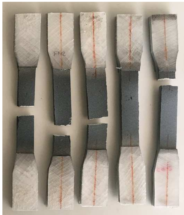
Figura 4.2 - Apresentação dos provetes usados nos ensaios de tração de resina Sikadur-30® após a rotura.
