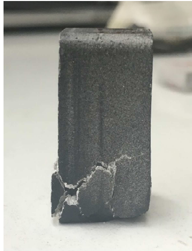
Figura 4.8 – Pormenor da rotura do provete de resina Sikadur-30®
