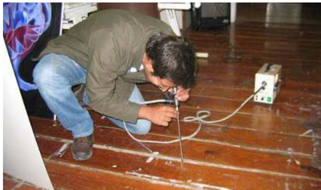
Figura 8. Utilização do videoscópio para visualização de um pavimento do Palácio de Belomonte, séc. XVIII, Porto.
