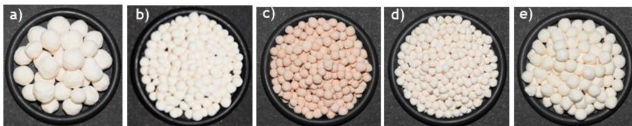
Figure 2- Zeolite: a) 4A BFK 2.5-5.0 mm; b) 4A BFK 1.6-2.5 mm; c) 4A BFK HSD 1.6-2.5 mm; d) 13X BFK 1.2-2.0 mm; e) 13X BFK 6x8 mesh.
