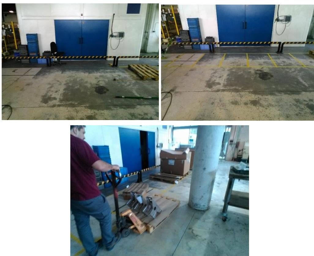
Figura 24 - Chão do setor sem marcação de zonas para receção e expedição de paletes (topo esquerdo). Chão do setor com marcações para paletes (topo direito). Colaborador a colocar o material nas marcações (inferior centro).
