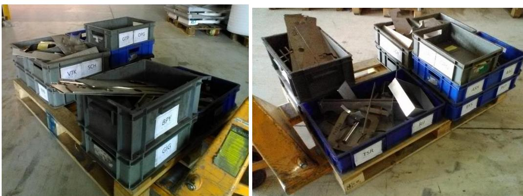
Figura 19 - *Gabarits* de soldadura separados em caixas, por cliente. 2ª fase dos 5S.
