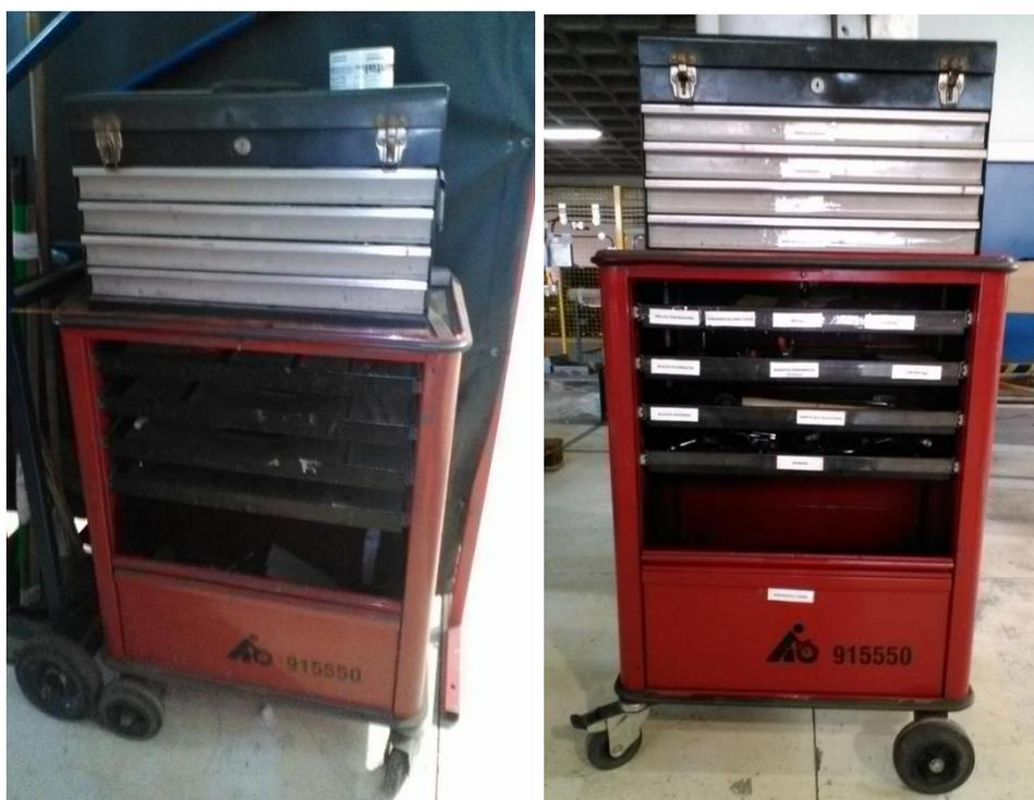
Figura 14 - Carro de ferramentas inutilizado e sujo (esquerda). Carro de ferramentas rehabilitado com divisórias com identificação (direita). Um dos resultados a aplicação da 2ª etapa dos 5S.
